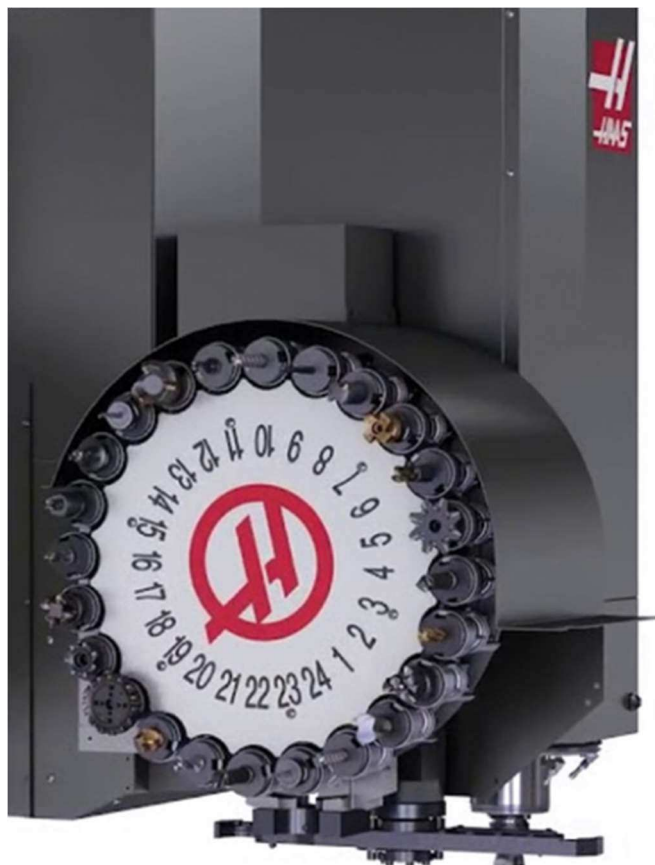
Obrázek 21 Výměna nástroje systémem zásobník – podavač - upínač od firmy Haas [26]
