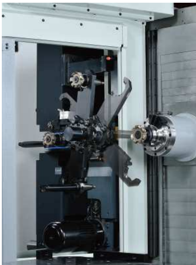
Obrázek 32 Pohyb zasekávacího výměnného ramene u CNC stroje [31]
