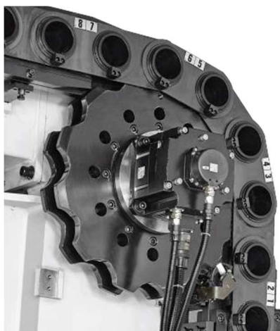
Obrázek 17a Segment s dvěma úložnými místy pro nástroje [12]
