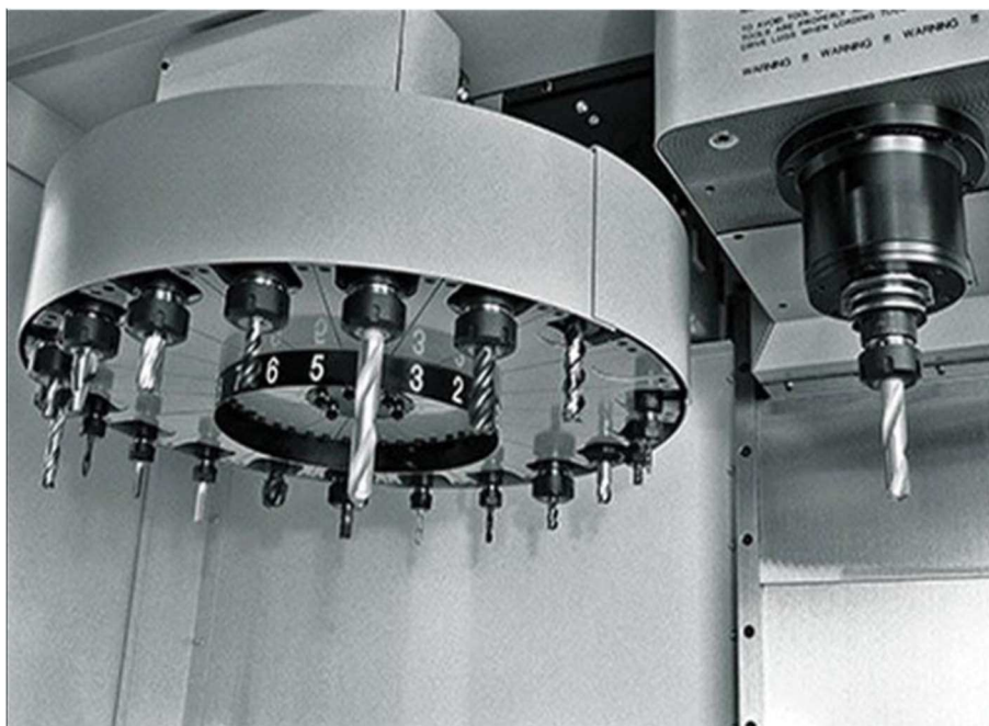
Obrázek 18 Pick-up výměna firmy Haas [26]
