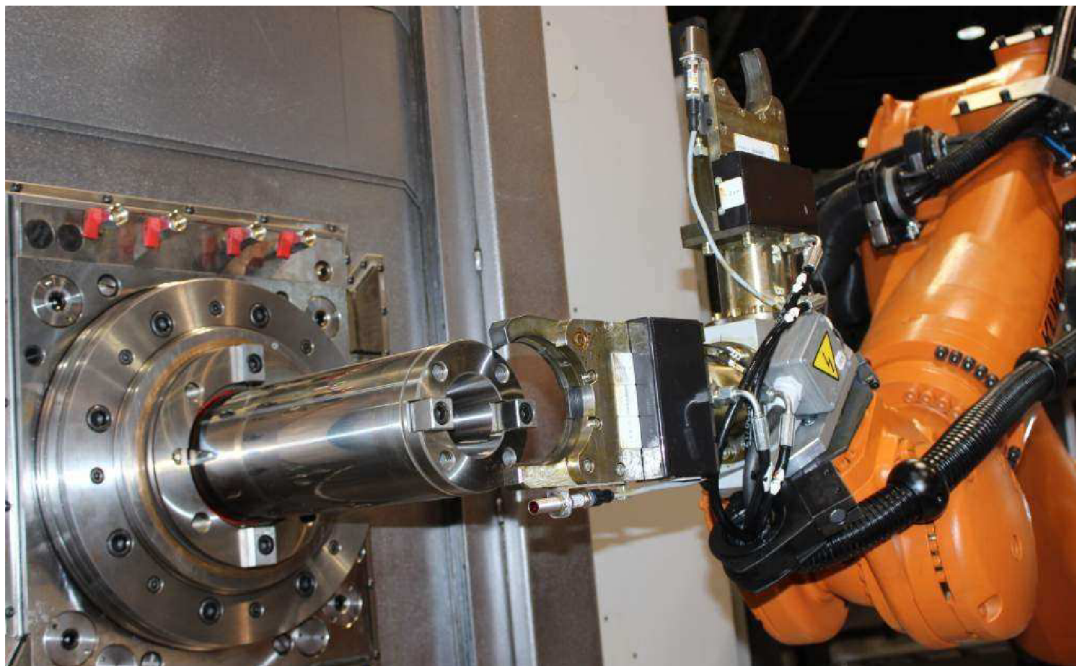
Obrázek 26 Detail koncového efektrou průmyslového robotu KUKA [8]
