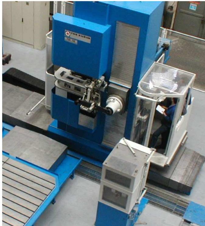
Obrázek 23 Systém AVN zásobník - manipulátor – podavač [29]
