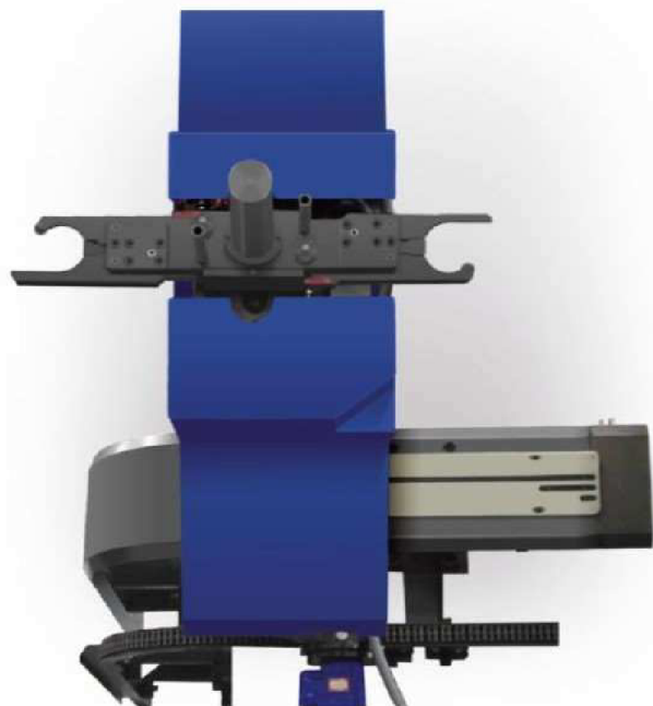
Obrázek 34 Napichovací způsob s jednou pohyblivou čelistí firmy TOS Varnsdorf [32]
