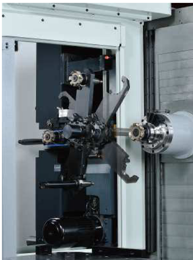
Obrázek 32 Pohyb zasekávacího výměnného ramene u CNC stroje [31]
