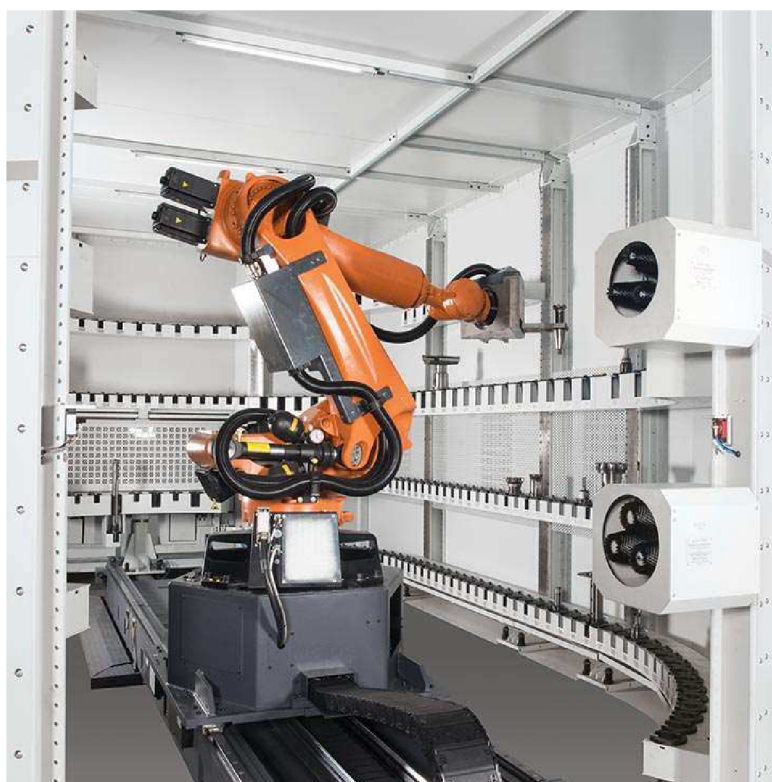
Obrázek 27 Systém AVN s pohyblivým průmyslovým robotem [9]
