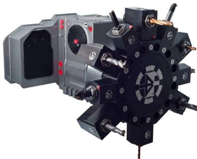
Obrázek 6 Uspořádání nástrojů po obvodu revolverové hlavy firmy Baruffaldi [15]
