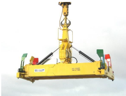
Obr. 1.15 Spreader s naklápěcí horní částí [25]
