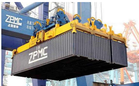
Obr. 1.12 Spreader s třemi kontejnery vedle sebe [22]
