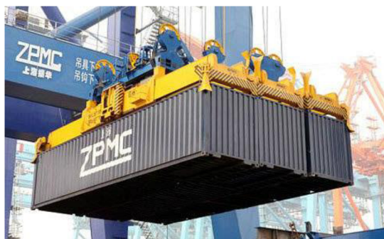
Obr. 1.12 Spreader s třemi kontejnery vedle sebe [22]
