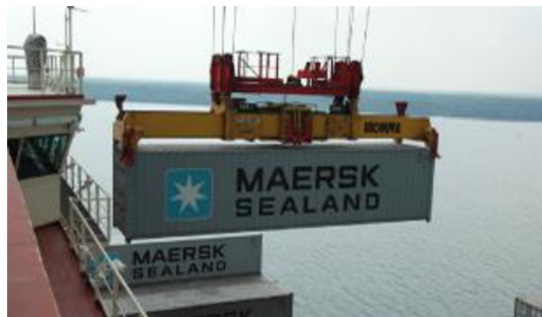
Obr.1.9 Jednoduchý spreader se systémem single lift [19]
