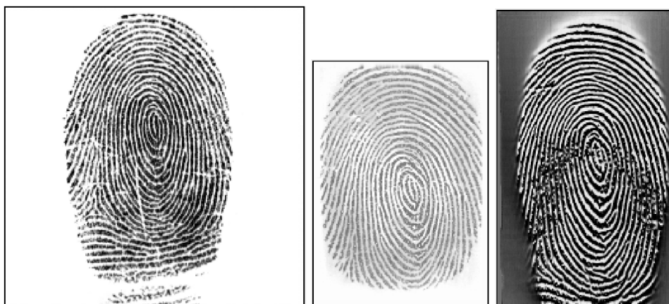
Obrázek 2.1: Otisk stejného prstu na různých typech snímačů. Zleva: Optický (FTIR), Polovodičový (Kapacitní), Polovodičový (Tepelný). Zdroj: [10].
