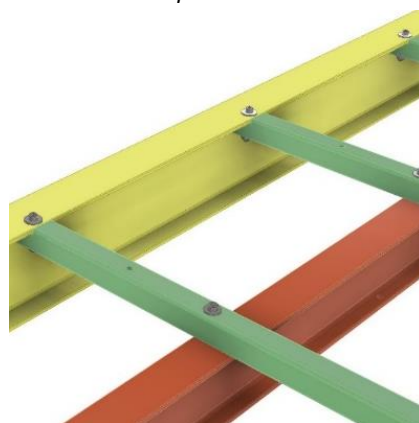
Obr. 5.8 – Spoj profilu ST 50×50/3,5 s ostatními prvky
