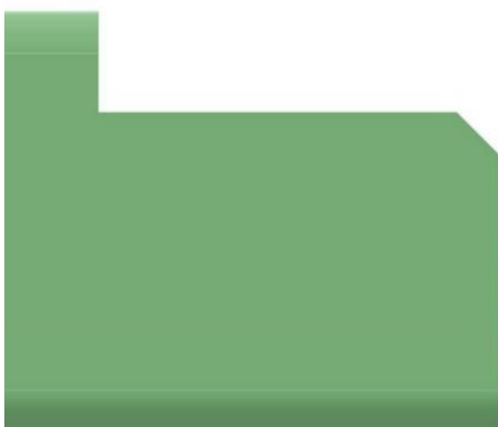
Obr. 5.7 – Zářez na konci profilu ST 50×50/3,5
