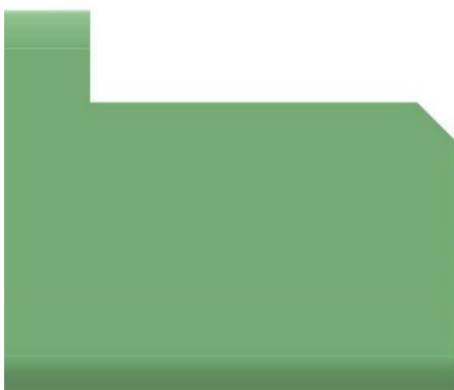
Obr. 5.7 – Zářez na konci profilu ST 50×50/3,5
