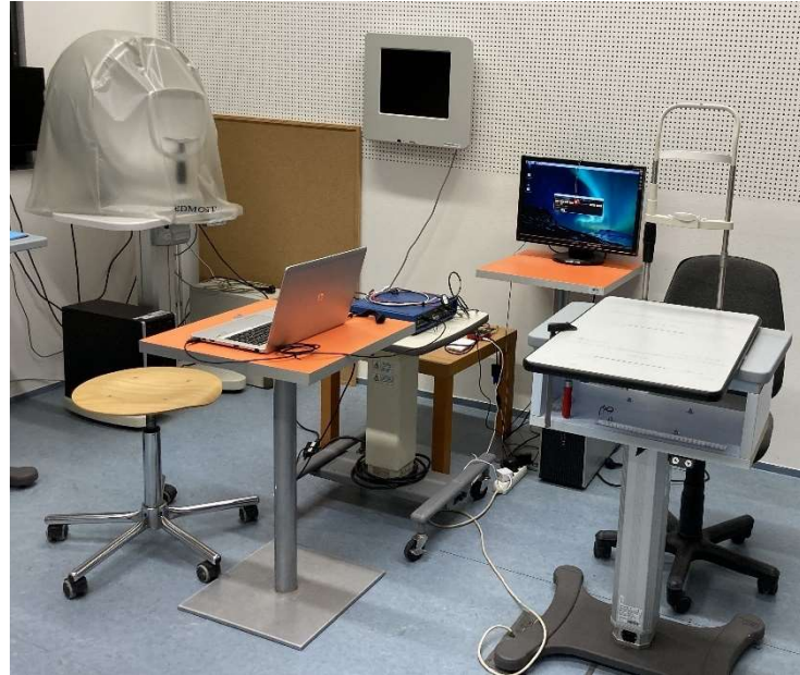
Obr. 7 – Fotografie konkrétního uspořádání laboratoře, kde probíhalo snímání metodou SSVEP. Na fotografii je patrný monitor s červeným fixačním světlem uprostřed obrazovky ve vzdálenosti 6 m od probanda (přes zrcadlo), dále stolek, kde proband fixoval hlavu v opěrce brady a čela, a BIOPAC MP35 připojený prostřednictvím USB kabelu k notebooku.
