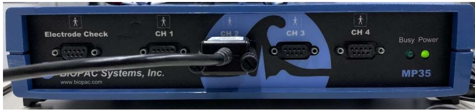
Obr. 6 – Konkrétní BIOPAC MP35, který byl použit ke snímání SSVEP.
