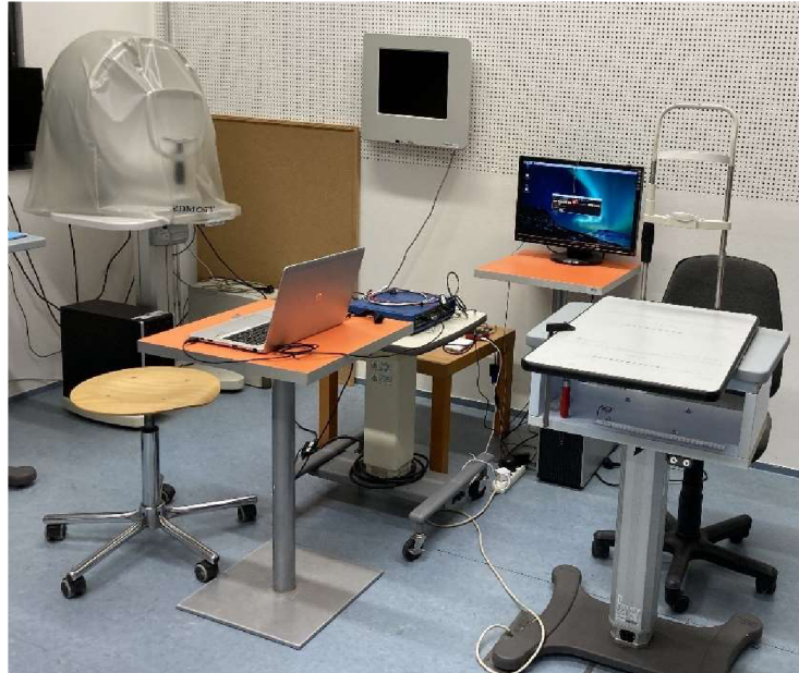
Obr. 7 – Fotografie konkrétního uspořádání laboratoře, kde probíhalo snímání metodou SSVEP. Na fotografii je patrný monitor s červeným fixačním světlem uprostřed obrazovky ve vzdálenosti 6 m od probanda (přes zrcadlo), dále stolec, kde proband fixoval hlavu v opěrce brady a čela, a BIOPAC MP35 připojený prostřednictvím USB kabelu k notebooku.
