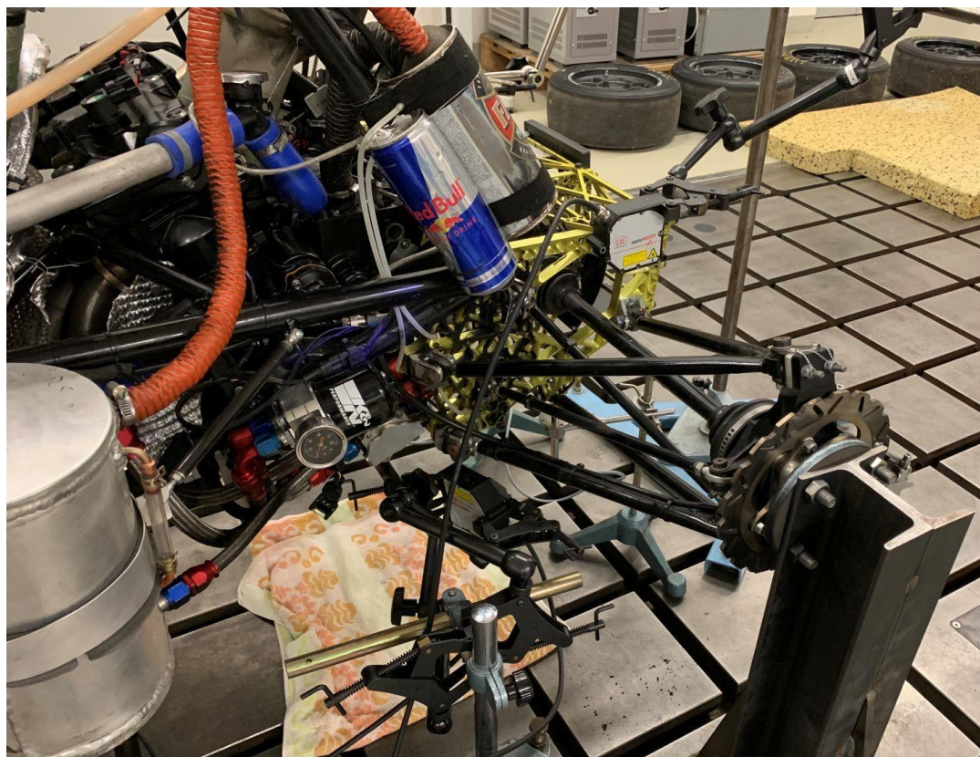
Obr. 4 Snímače zdvihu instalovány v druhém měření na levé straně
