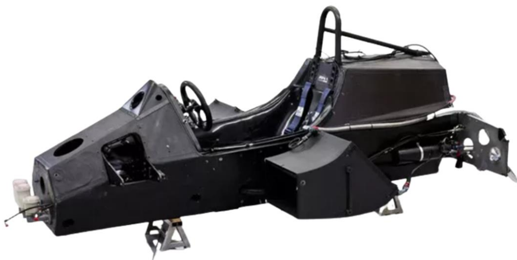
Obrázek 7 Kompozitní monokok monopostu McLaren MP4/1 [20]
