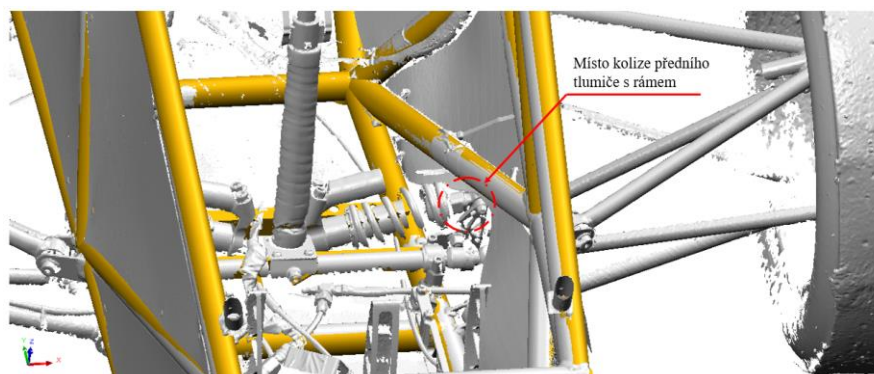
Obrázek 25 Kolize předního tlumiče s rámem monopostu FS06 [Archiv autora]
