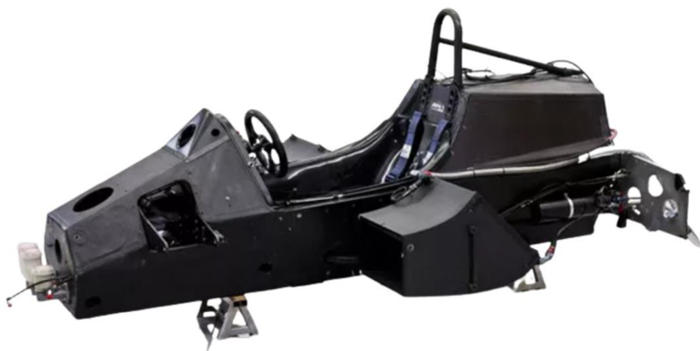
Obrázek 7 Kompozitní monokok monopostu McLaren MP4/1 [20]
