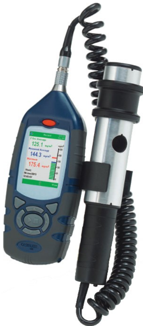
Obrázek 16 - Měřicí přístroj Casella CEL 712 MicroDust Pro (Casella, Bedford, Velká Británie) (Enviro-Equipment, 2021)
