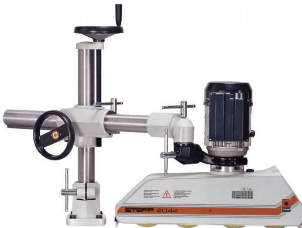
Obrázek 14 - Podavač materiálu MAGGI STEFF 2044 (Itálie) (Šimek, 2021)
