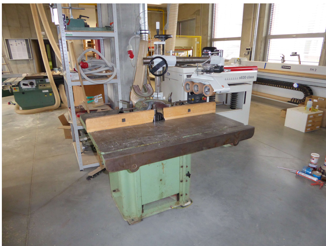
Obrázek 11 - Spodní svislá frézka FVS, ED, APT Line II (Tuttlingen, Německo)
