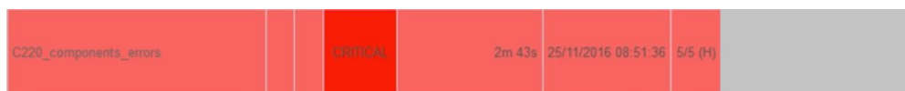
Obrázek 32: Centreon – reálný stav komponent vykazovaný systémem Centreon po způsobení závady otevřením krytu tiskárny KM bizhub C220
