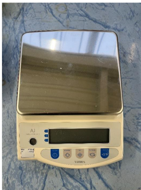
Obrázek 11: Laboratorní váha Vibra AJ 6200
