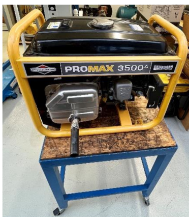
Obrázek 10: Mobilní generátor ProMax 3500A
