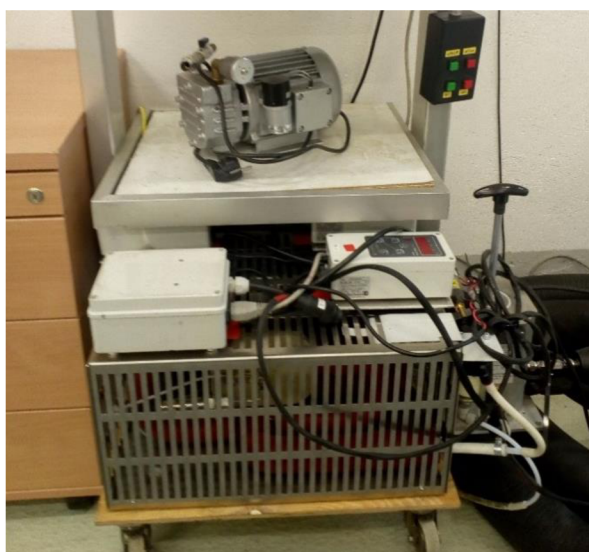
Obrázek 12: FTIR analyzátor Bruker
