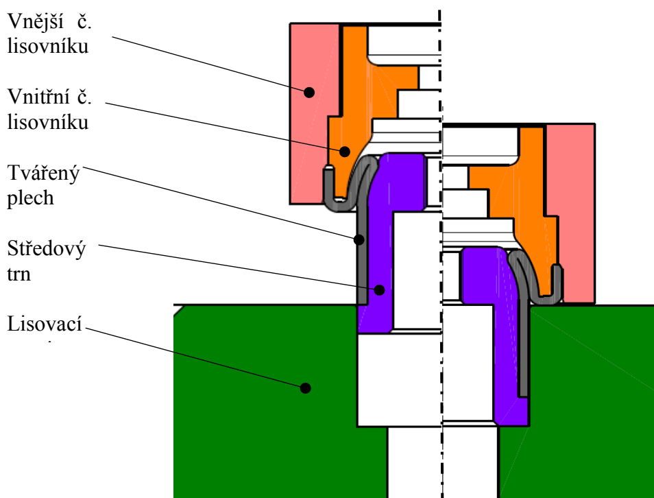
Obr. 47 Schéma nástroje a jeho funkce pro operaci 100
