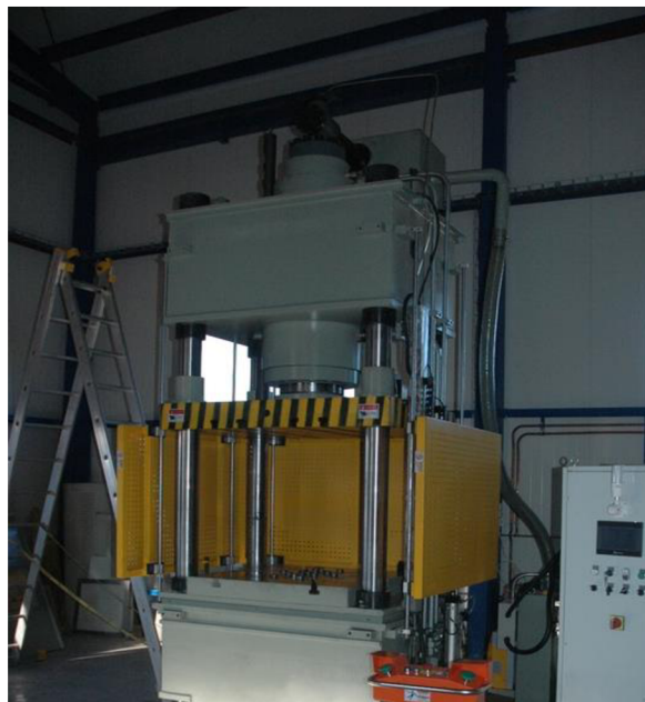
Obr. 32 Hydraulický lis SHPFS 250
