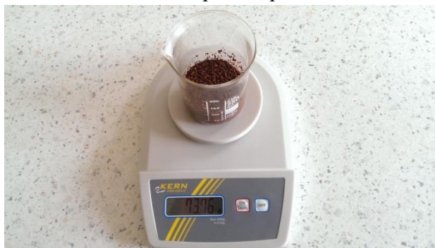
Obr. 32 Vážení nasátého sorpčního prostředku Absodan Plus
