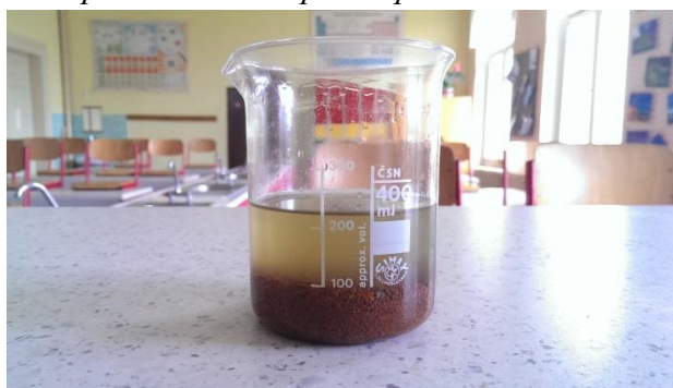
Obr. 31 Sorpce benzínu sorpčním prostředkem Absodan Plus
