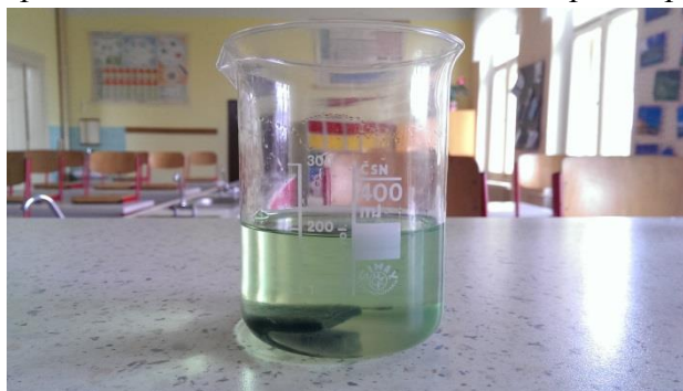
Obr. 37 Sorpce benzínu univerzálním textilním sorpčním prostředkem
