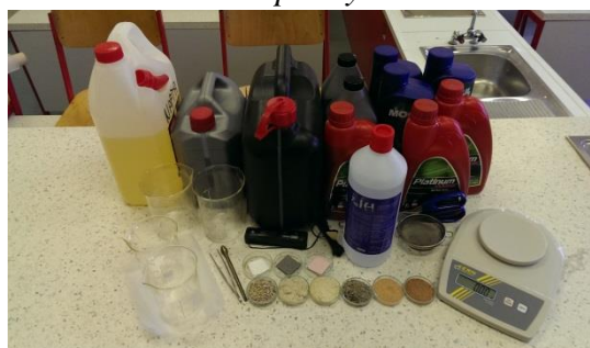
Obr. 29 Pomůcky pro měření sorpční kapacity
