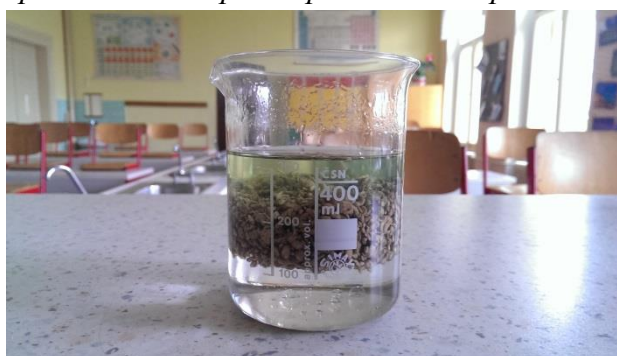
Obr. 34 Sorpce benzínu sorpčním prostředkem Spilkleen Oil Selective
