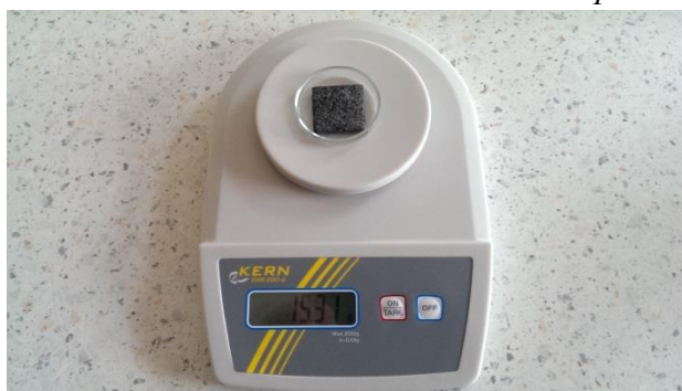
Obr. 38 Vážení nasátého univerzálního textilního sorpčního prostředku
