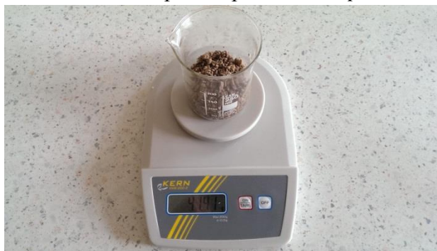
Obr. 35 Vážení nasátého sorpčního prostředku Spilkleen Oil Selective
