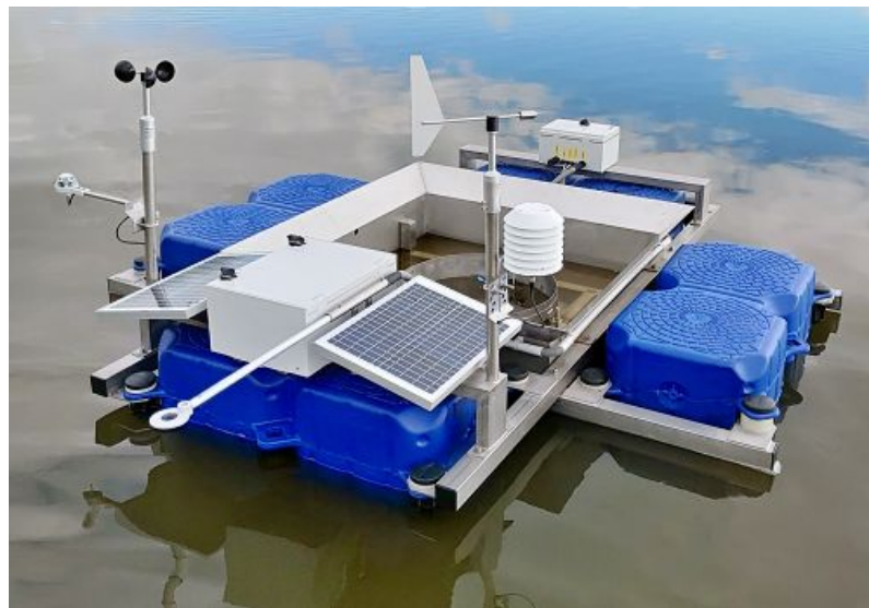
Obr. 3.7: Plovoucí výparoměr značky Fiedler[18]
