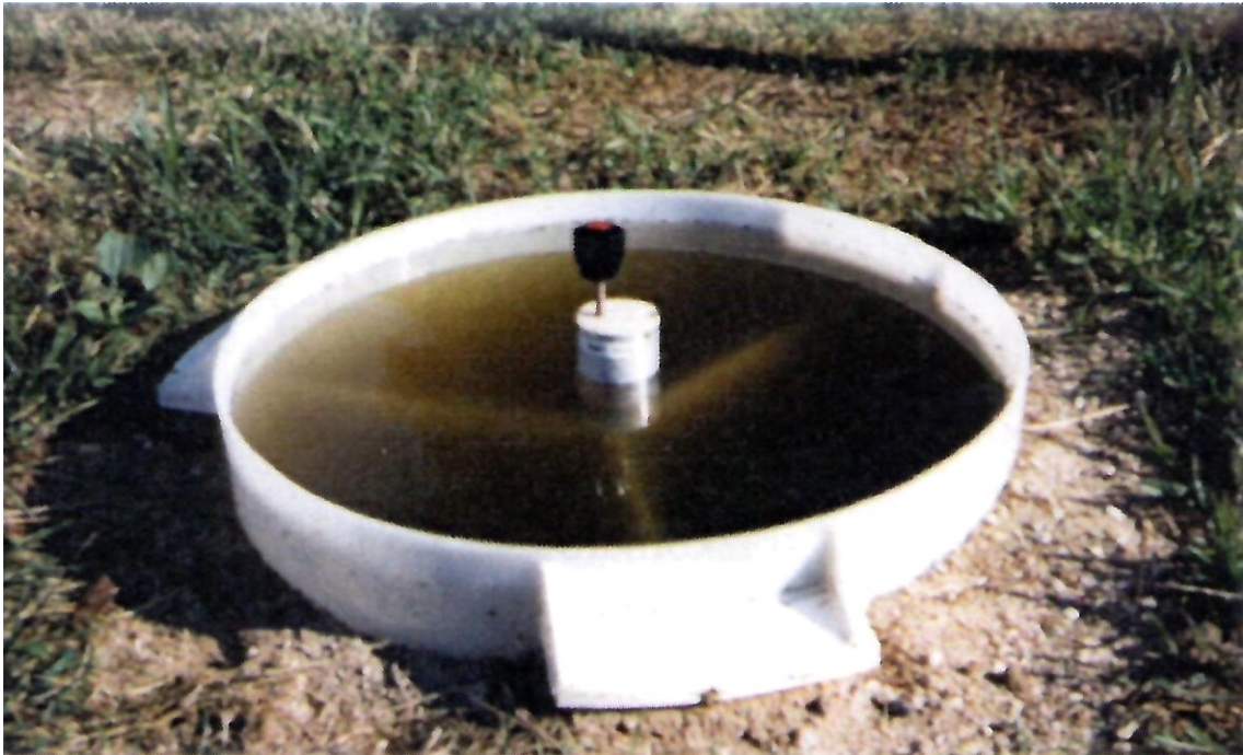
Obr. 3.14: Detail výparoměru GGI-3000 v Holovousích (AMET Velké Bílovice)
