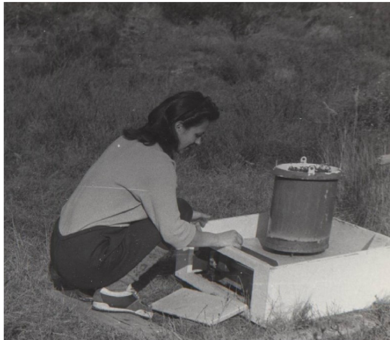
Obr. 3.6: Vážení výparoměru GGI-500-30 [17]
