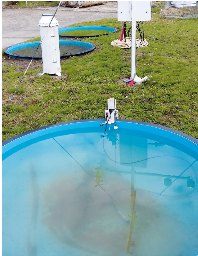
Obr. 3.11: Výparoměrné bazény v Podbabě (vpředu čistá voda, uprostřed bazén se solným roztokem a v pozadí zelená „vykvetlá“ voda. [11]
