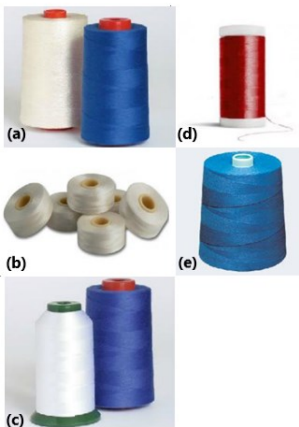
Obrázek 2: (a) kuželová, (b) válcová, (c) kuželová se zkoseným čelem, (d) válcová přírubová, (e) king cívka
