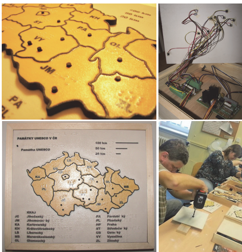
Obr. 44 – Spouštěcí čidla multimediální tyflomapy (vlevo nahoře), realizace ozvučení a napojení na zvukový modul (vpravo nahoře), výsledná multimediální tyflomapa (vlevo dole) a „manufakturní“ výroba (vpravo dole)
