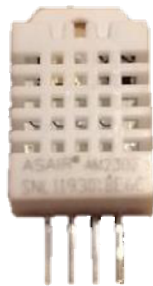
Obr. 11: Senzor teploty a vlhkosti DHT22
