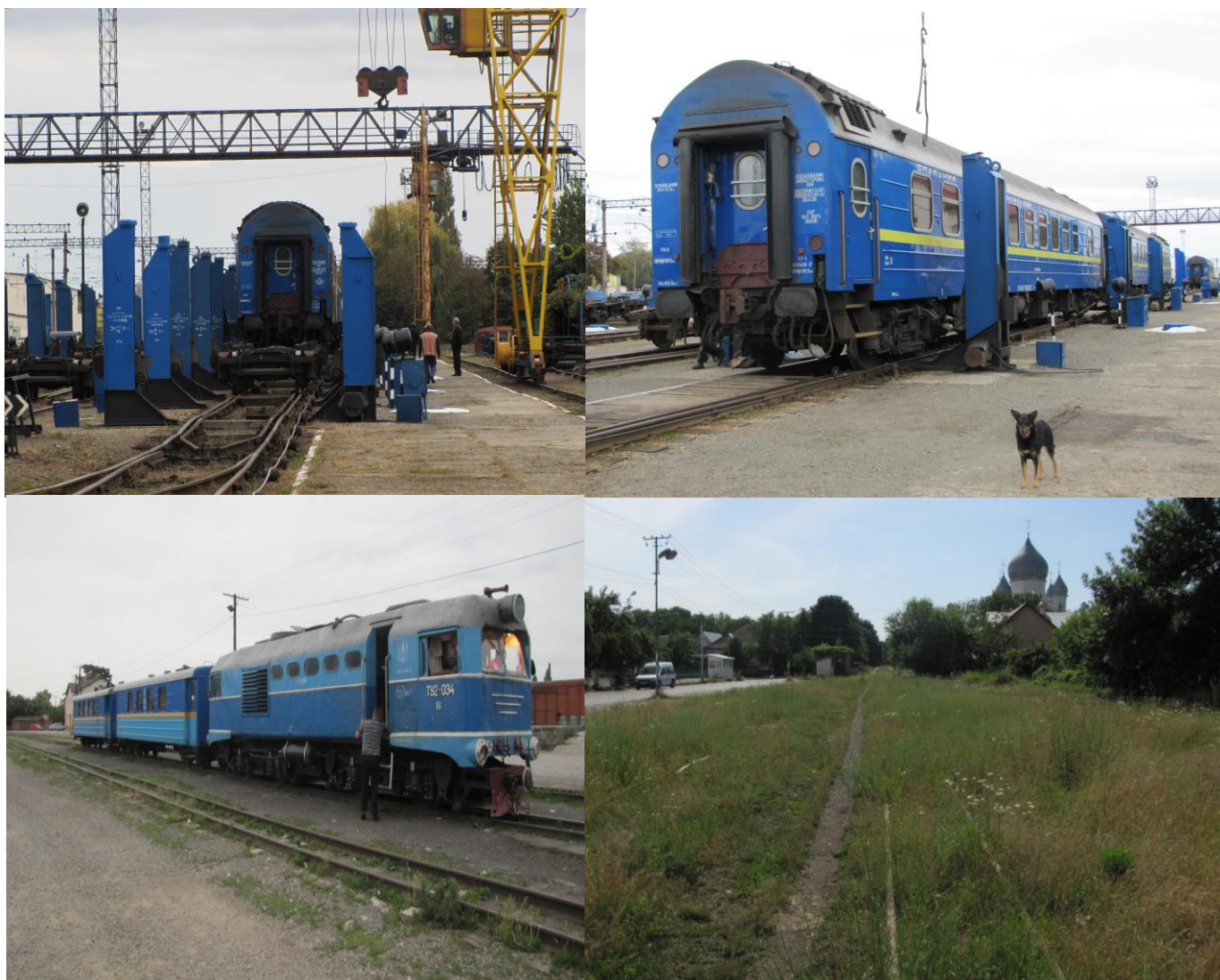
Obr. 1 a obr. 2: Zařízení pro výměnu podvozků v žst. Čop (říjen 2016)
