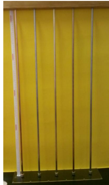
Obrázek 27: Demonstrační pomůcka – sjíždění magnetek po tyči
