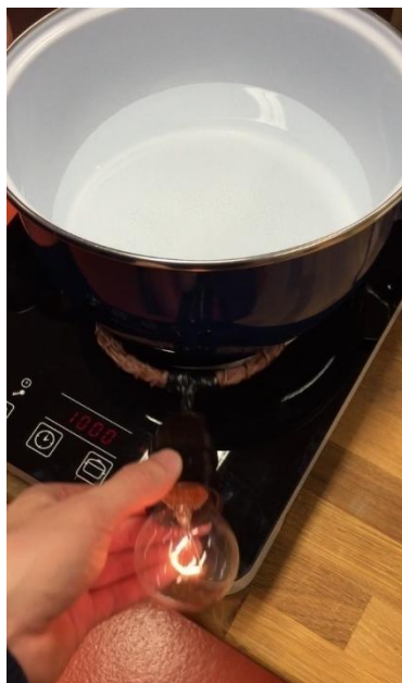
Obrázek 24: Rozsvícení žárovky na indukčním vařiči
