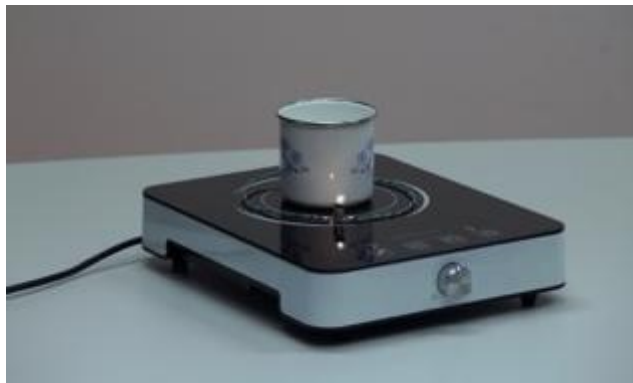
Obrázek 23a, b: Rozsvícení žárovky na indukčním vaříči
