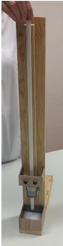
Obrázek 39: Pomůcka k demonstraci indukovaného napětí
