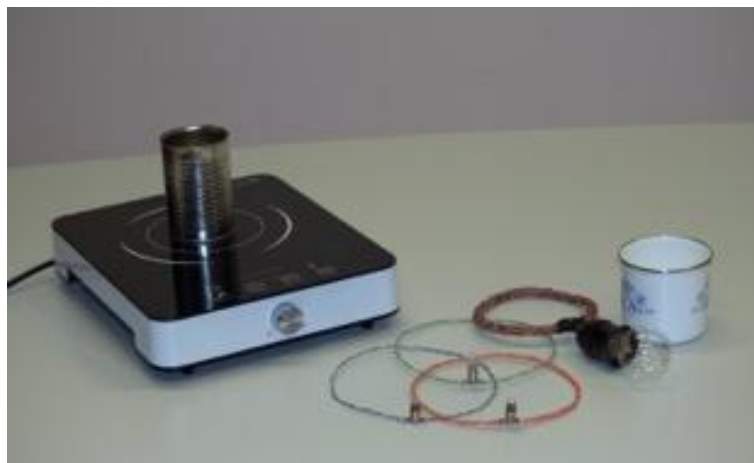
Obrázek 22: Pomůcky – indukční vařič jako transformátor
