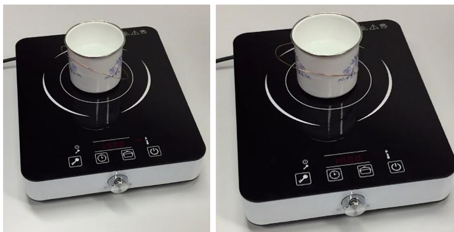
Obrázek 20: Levitace kovového kroužku
