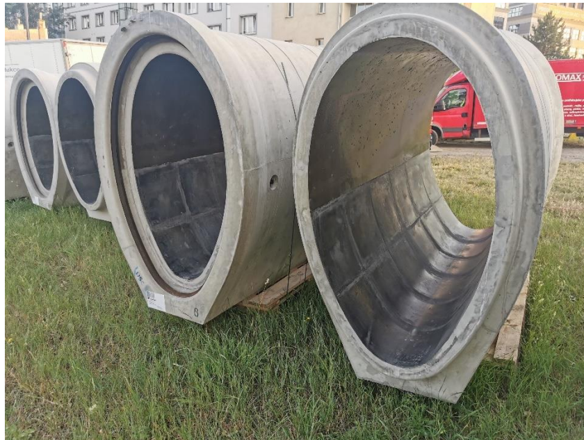
Obr. 5-3 – železobetonové vejčité trouby [zdroj: Lukáš Havlíček]
