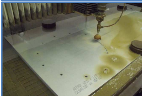
Obr. 6.14 Řezání vnitřního otvoru \phi 520 mm (proti směru hodinových ručiček)
