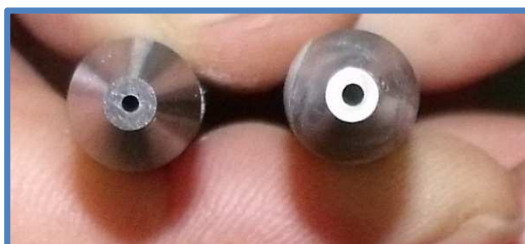
Obr. 6.9 Nová zaostřovací trubice (vlevo), stará zaostřovací trubice
