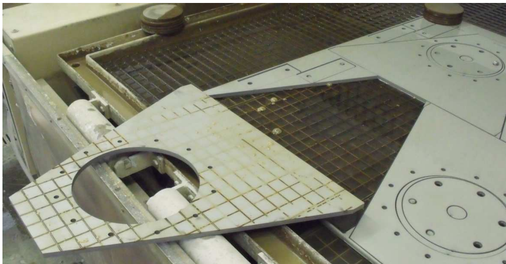
Obr. 2.28 Povrchová textura spodní části obrobku vzniklá v místě dotyku s rošty
