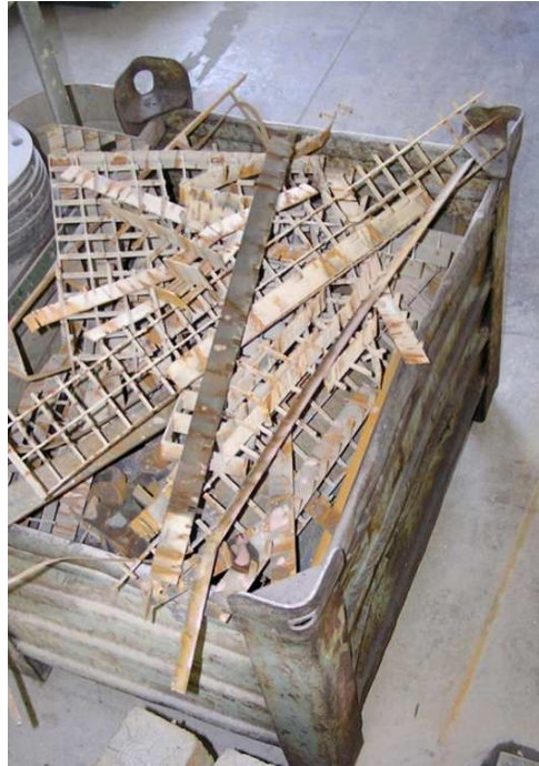
Obr. 2.27 Vedlejší produkt AWJ - odpad ve formě prořezaných roštů
