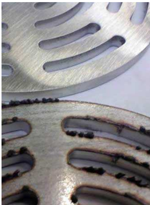
Obr. 2.26 Porovnání řezu AWJ vs. Laser [34]
