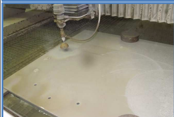
Obr. 6.13 Řezání šestého otvoru \phi 12
