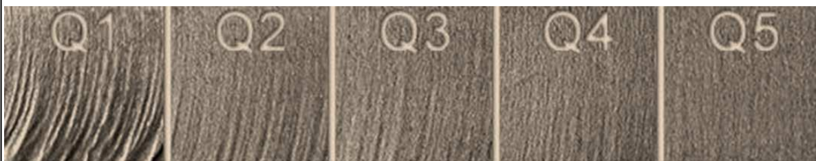
Obr. 2.7.3 Druhy dosažitelných povrchů pomocí metody AWJ [34]
