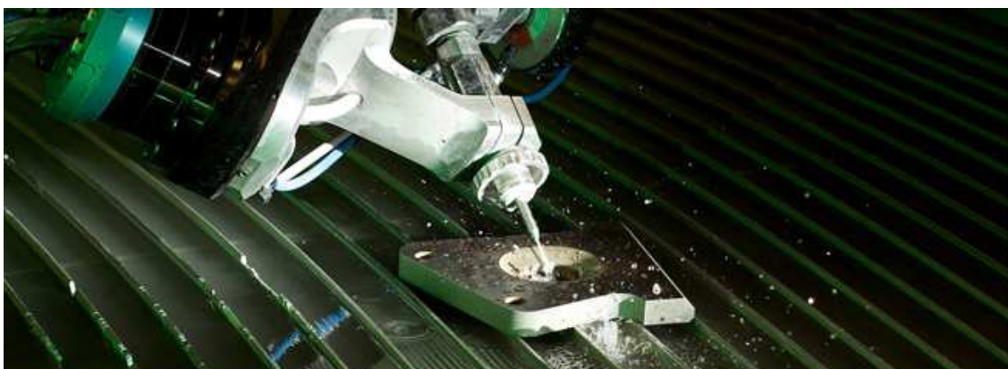
Obr.2.4 Dynamicky řízená hlava vodního paprsku [10]
