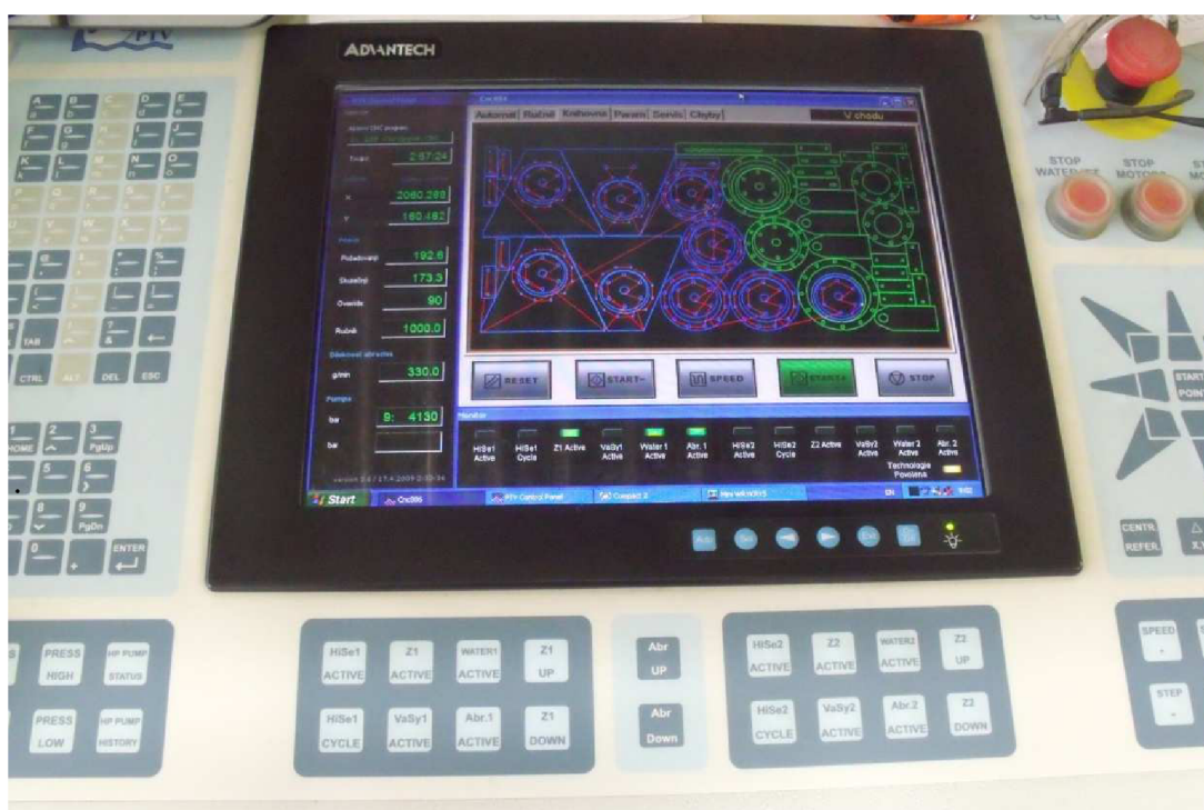
Obr. 3.2 Ovládací panel firmy PTV s řídicím systémem Cnc886/Win
