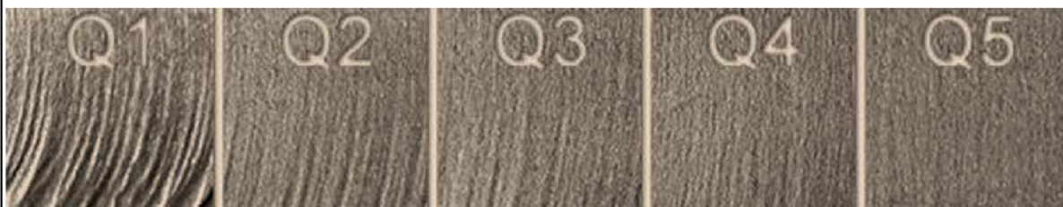
Obr. 2.7.3 Druhy dosažitelných povrchů pomocí metody AWJ [34]
