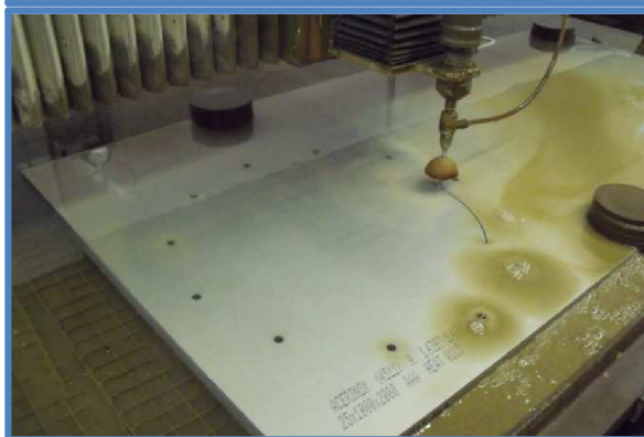
Obr. 6.14 Řezání vnitřního otvoru \varnothing 520 mm (proti směru hodinových ručiček)
