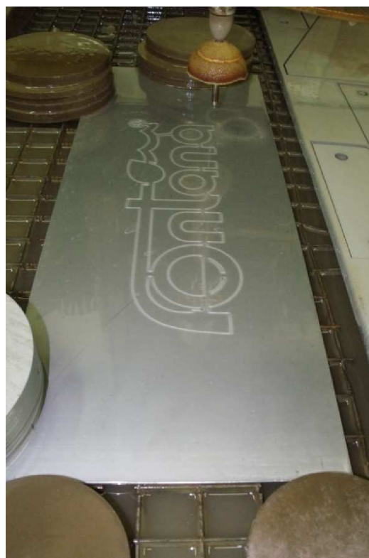
Obr. 2.25 Gravírování nerez oceli 1.4301
