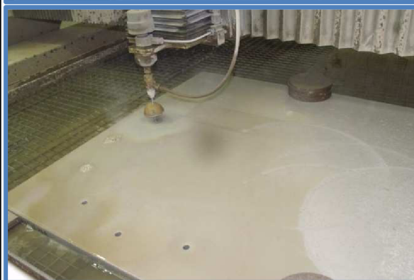
Obr. 6.13 Řezání šestého otvoru \varnothing 12
