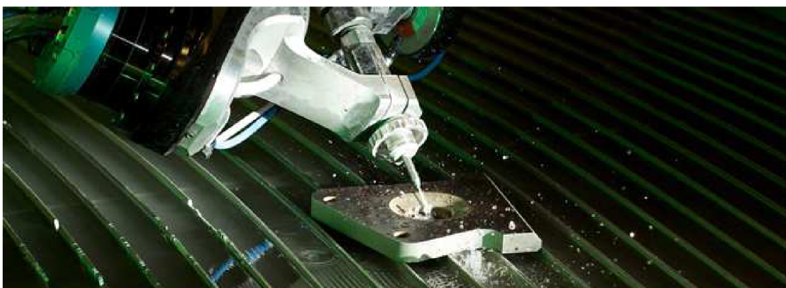
Obr.2.4 Dynamicky řízená hlava vodního paprsku [10]
