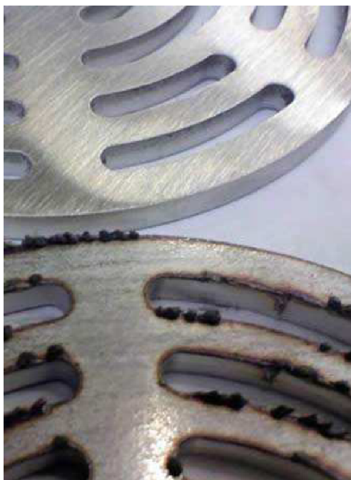
Obr. 2.26 Porovnání řezu AWJ vs. Laser [34]
