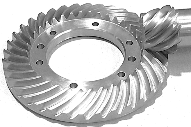
Obr. 2.4 Šroubovitý pohyb ozubených kol [20].
