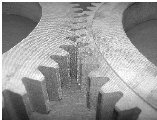
Obr. 2.3 Valivý pohyb ozubených kol [20].
