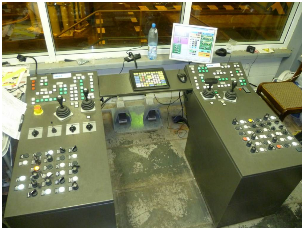
Obr. 3.3 Centrální ovládací pracoviště integrovaného souboru CKVX 2500 + QKK 8 [17]
