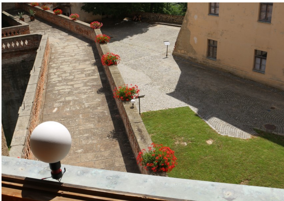
obr. 6.1 - pohled na nádvoří z okna 3NP, koule použité jako navazovací body při LS
