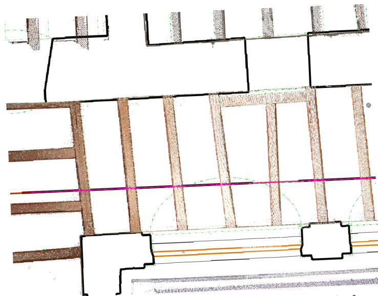
obr. 8.2 - řez bodovým mračnem v úrovni stropních trámů
