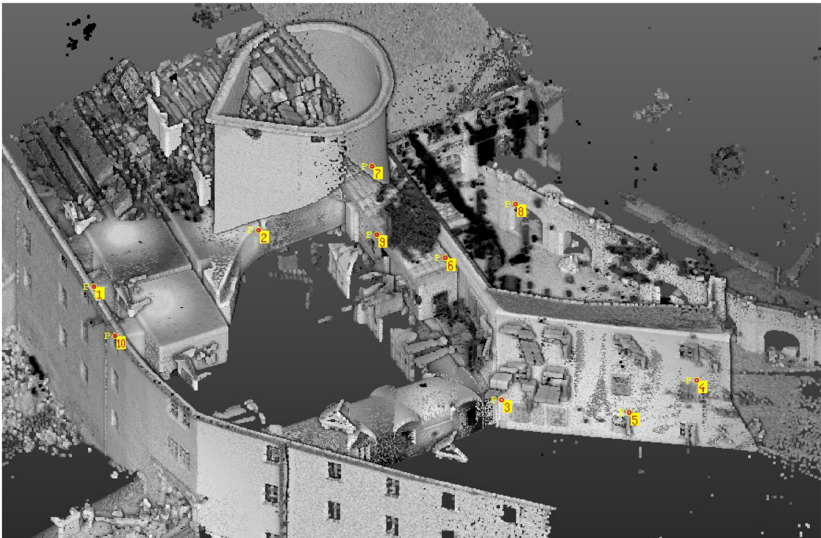
obr. 7.3 - TR, rozmístění vlícovacích bodů v mračnu
