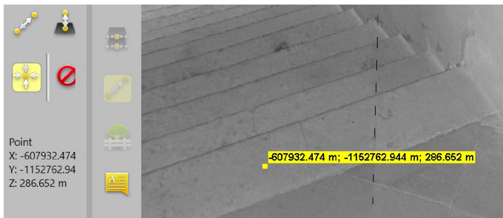
obr. 7.7 - TR Scan explorer Viewer, určení výšky úrovně vstupu do 3NP
