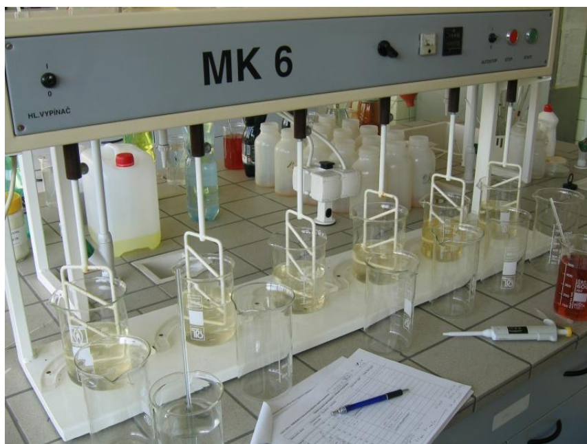
Foto č. 6: Koagulační sklenicové testy na míchadle MK6. (fotografie Kubišta, 2011)
