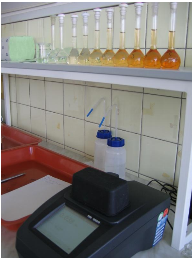
Foto č. 7: Měření kalibrační křivky \text{NH}_4^+ na přístroji HACH DR 2800. (fotografie Kubišta, 2011)
