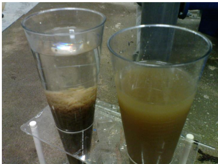
Foto č. 3: Koagulační sklenicový test, při stejných časech a dávkách koagulantu, po levé straně přidání polyflokulantu. (fotografie Kubišta, 2009)
