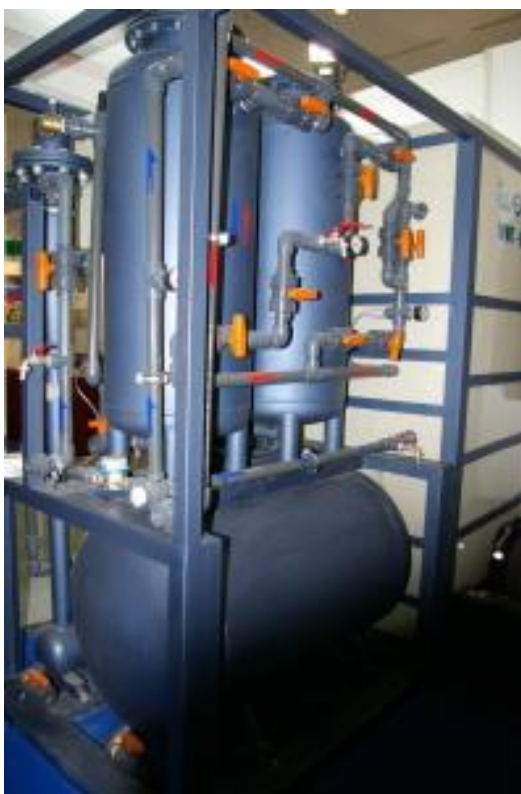
Foto č. 4: Převratitelná úpravna povrchové vody s koagulační filtrací firmy IWET a. s. . (fotografie Kubišta, 2007)
