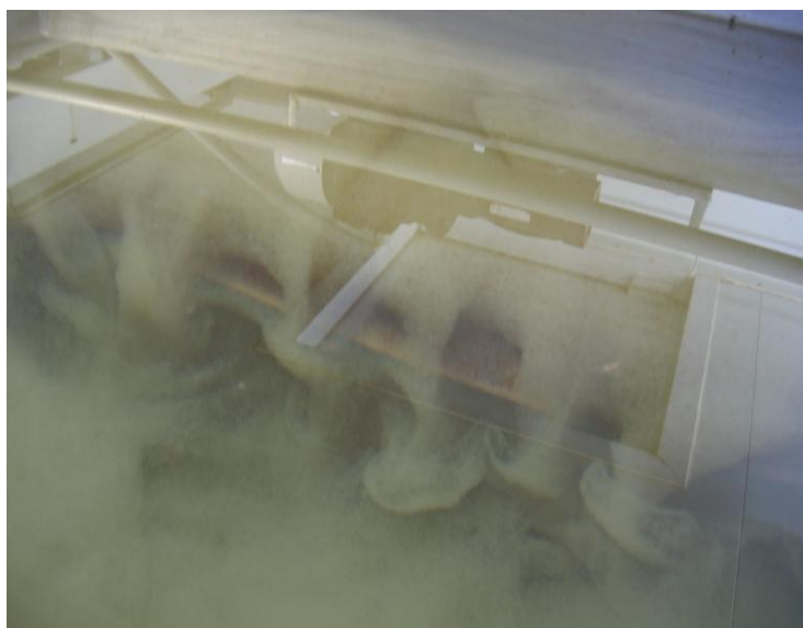
Foto č. 2: Tvorba vloček koagulací v čiřiči, tzv. vločkový mrak. (fotografie Kubišta, 2009)
