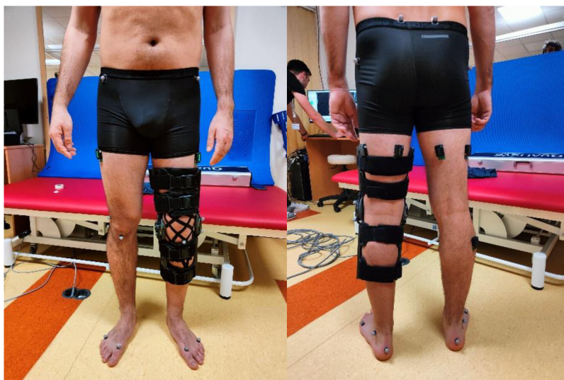
Obr. 29 Umístění markerů a senzorů EMG na dolních končetinách subjektu (Zdroj: autor)
