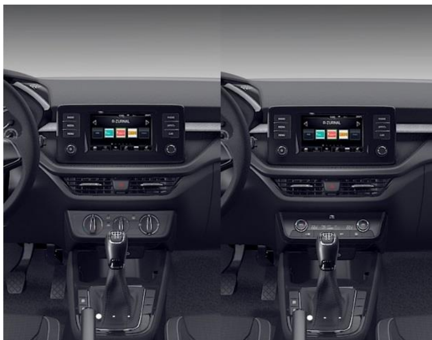
Obrázek 28 Ovládání manuální klimatizace na levé straně, ovládání automatické klimatizace v pravé části, Zdroj (22)
