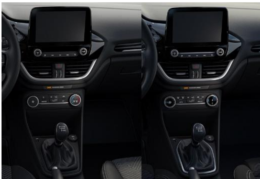
Obrázek 30 Ovládání manuální klimatizace na levé straně, ovládání automatické klimatizace v pravé části, Zdroj (24)
