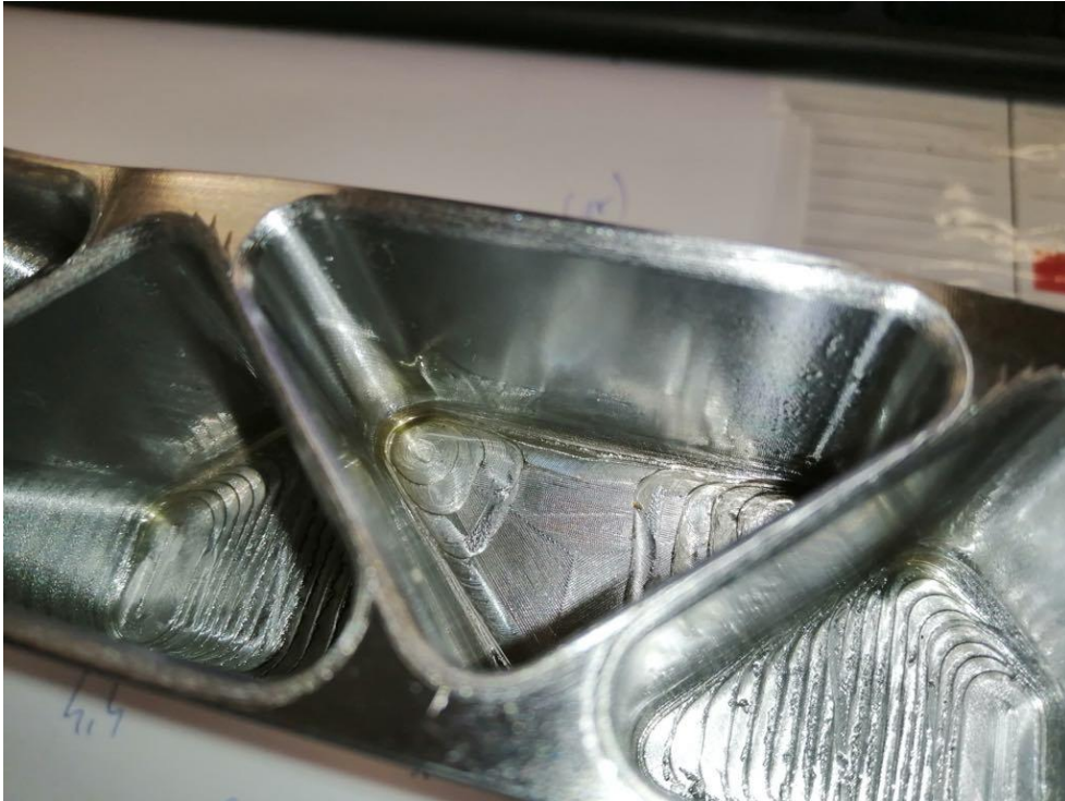
Obrázek 11 - Vada vlivem použití jiného nástroje
