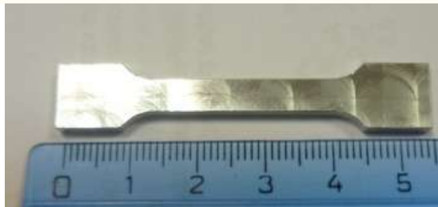
Obr. 3.29: Vypreparovaná zkušební tyčinka (dole), rozměry zkušební tyčinky (nahore)
