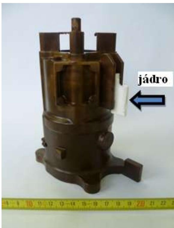
Obr. 3.5: Voskový model s vyplavitelným jádrem
