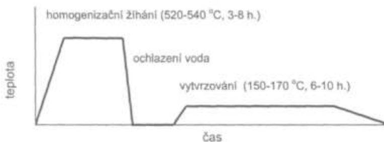
Obr. 2.27 Diagram tepelného zpracování při vytvrzování za tepla [6]
