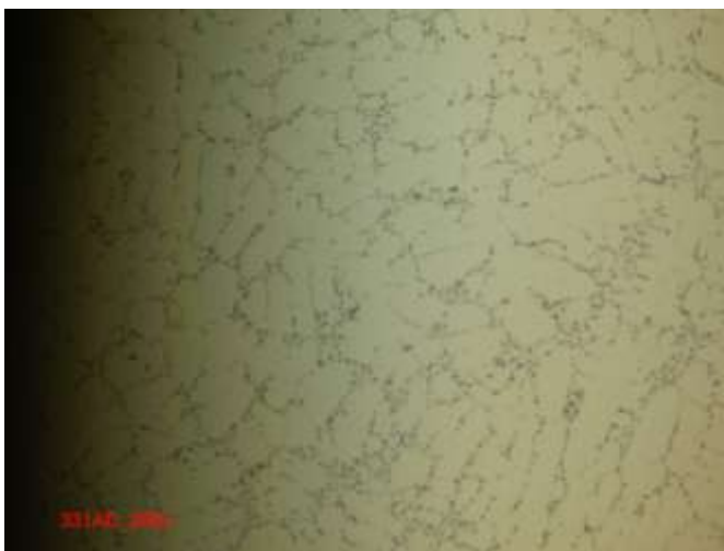
Obr. 4.11: JFKcasting – HIP + TZ zvětšení 200x
