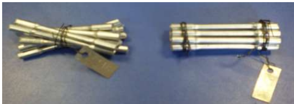
Obr. 3.20: Svazky zkušebních tyčinek – starý způsob (vlevo), nový způsob (vpravo)
