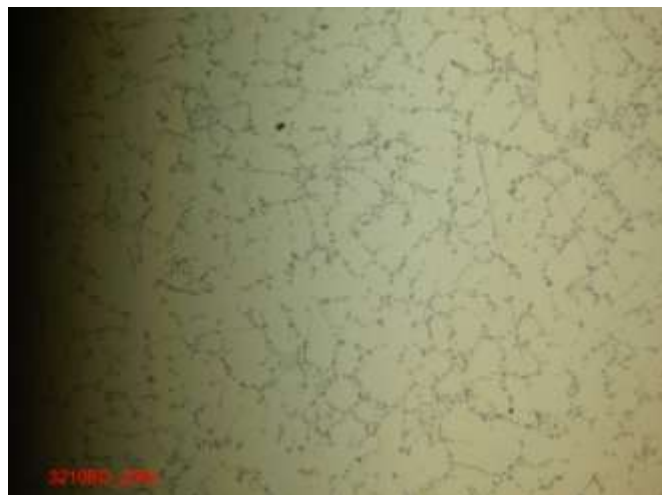
Obr. 4.10: JFKcasting - TZ zvětšení 200x
