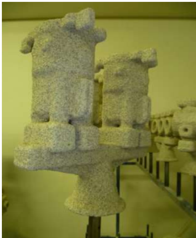
Obr. 3.9: Sušení skořepinové formy
