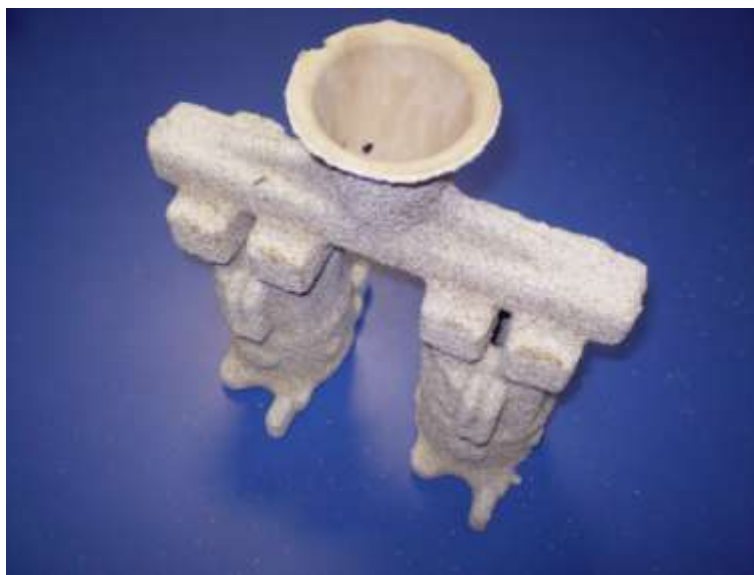
Obr. 3.10: Připravená skořepinová forma
