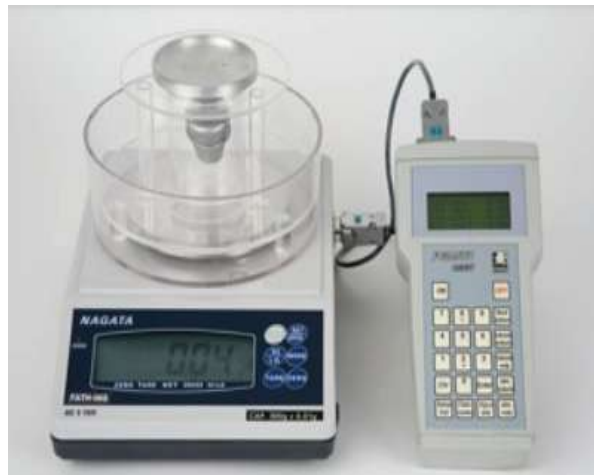
Obr. 2.28: Zařízení na měření naplynění [21]
