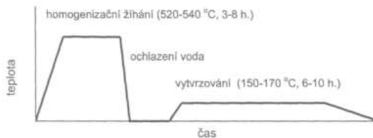
Obr. 2.27 Diagram tepelného zpracování při vytvrzování za tepla [6]
