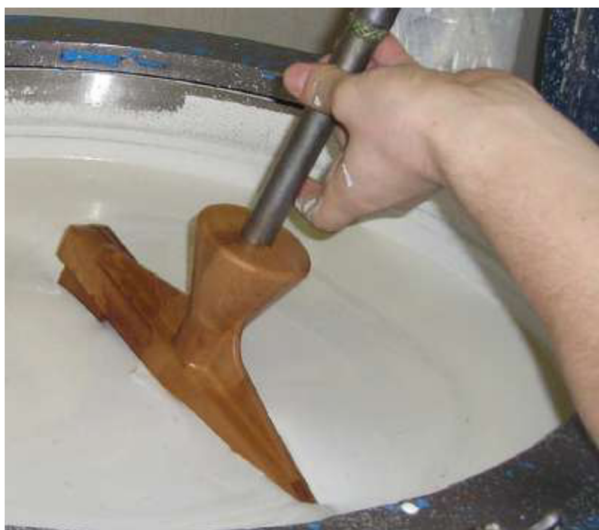
Obr. 3.7: Nanášení keramické suspenze
