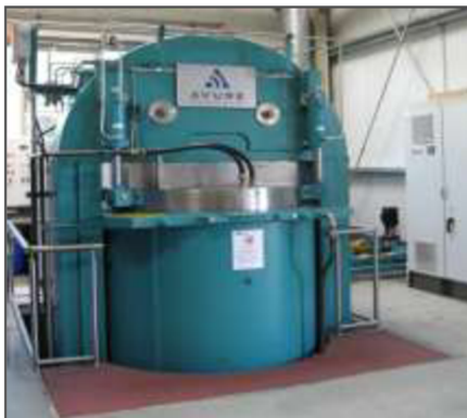
Obr. 2.21 HIP jednotka pro proces Densal II (Ø 1190 x 1390 mm) [15]
