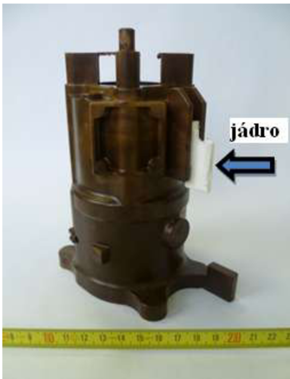
Obr. 3.5: Voskový model s vyplavitelným jádrem
