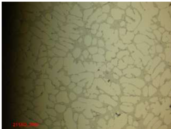
Obr. 4.6: JFcasting - LS zvětšení 200x
