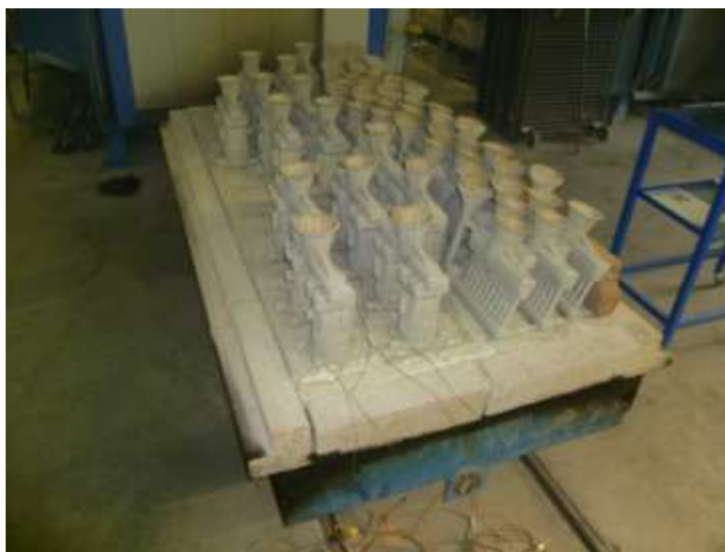
Obr. 3.12: Rozložení skořepinových forem v žíhací peci
