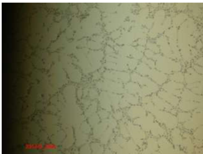
Obr. 4.8: JFcasting – HIP + TZ zvětšení 200x
