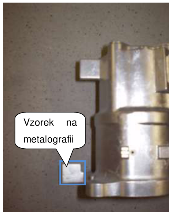
Obr. 3.24: Odběr vzorku z odlitku
