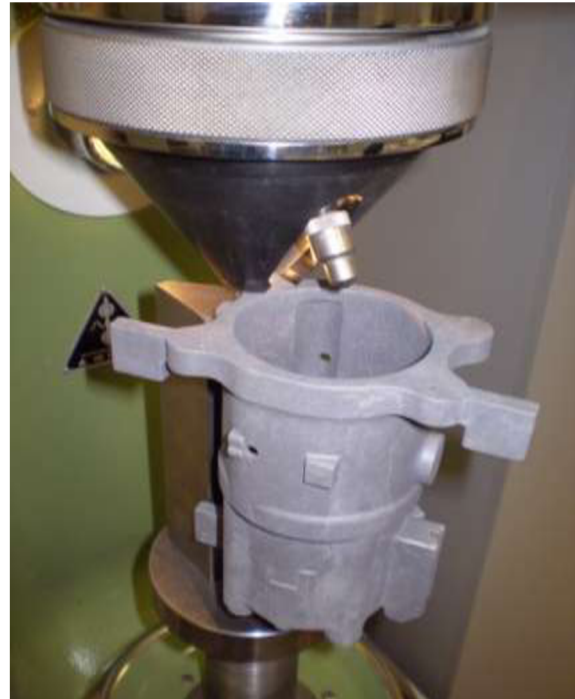
Obr. 3.23: Měření tvrdosti odlitku
