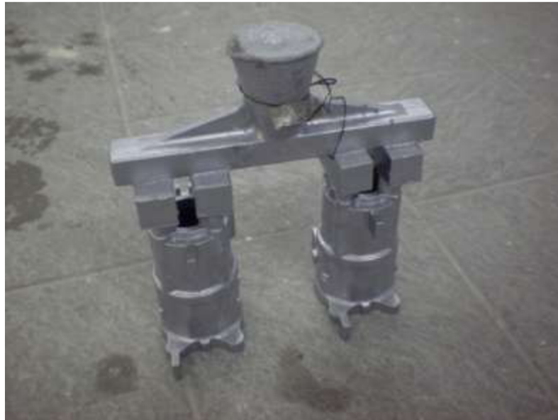
Obr. 3.18: Odlitky po vodním tryskání
