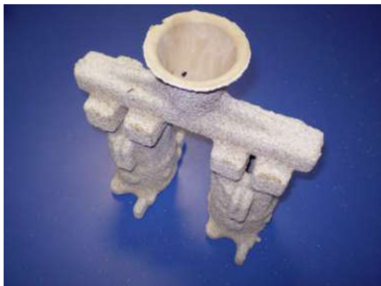
Obr. 3.10: Připravená skořepinová forma
