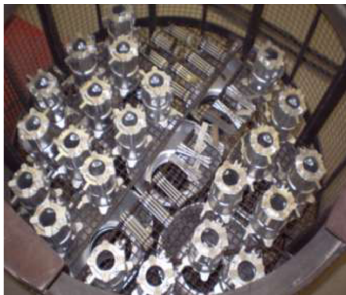
Obr. 3.21: Umístění odlitků a zkušebních tyčinek v koši na RŽ
