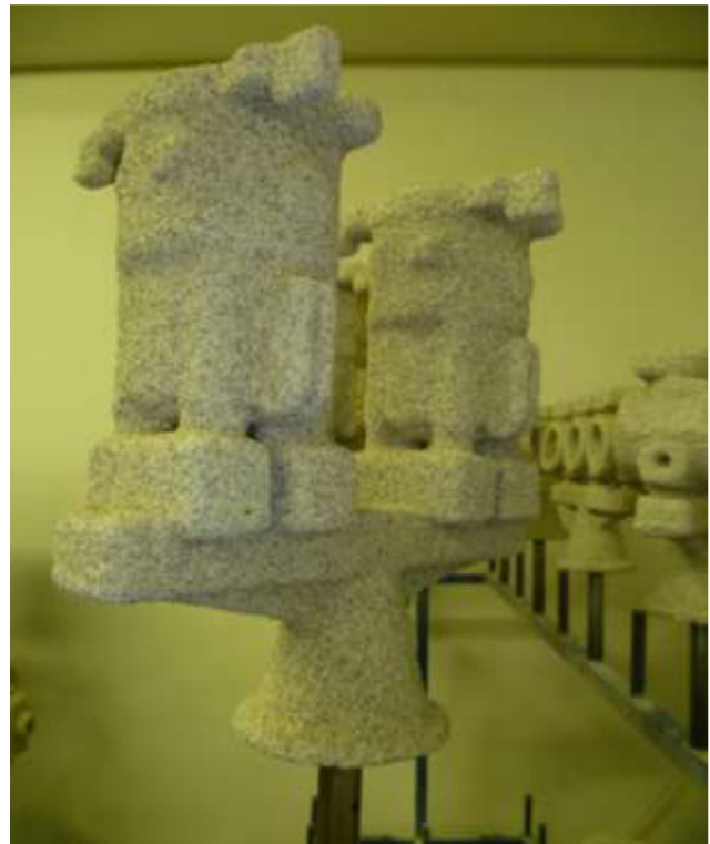
Obr. 3.9: Sušení skořepinové formy
