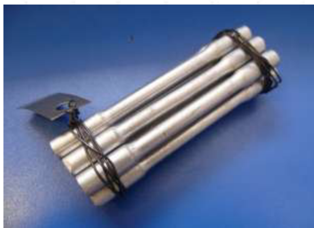
Obr. 3.30: Samostatně lité zkušební tyčinky (dole), rozměry zkušební tyčinky (nahore)
