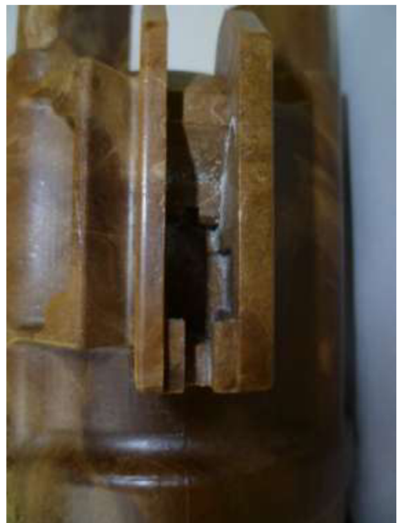
Obr. 3.6: Detail dutiny od vyplavitelného jádra
