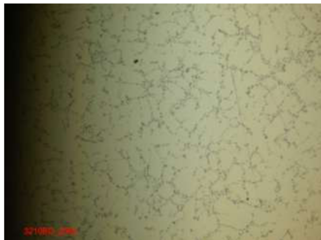
Obr. 4.10: JFKcasting - TZ zvětšení 200x
