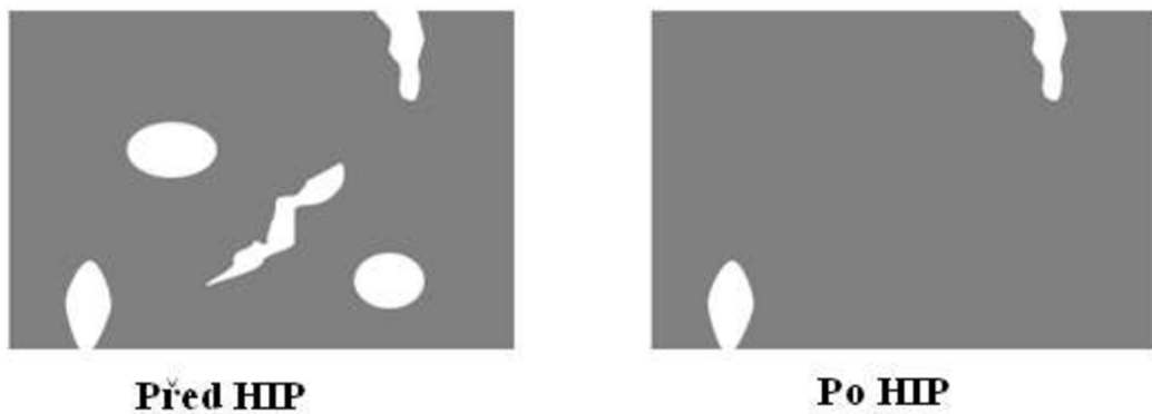
Obr. 2.18 Vnitřní a vnější vady před a po HIP [15]
