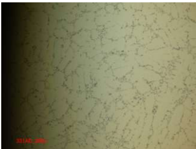
Obr. 4.11: JFKcasting – HIP + TZ zvětšení 200x
