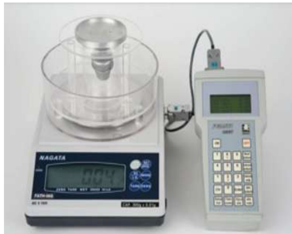
Obr. 2.28: Zařízení na měření naplynění [21]
