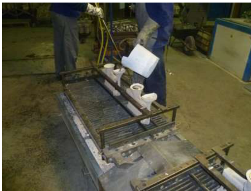
Obr. 3.17: Odlévání zkušebních tyčinek
