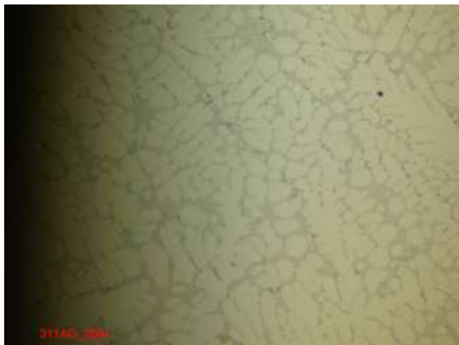
Obr. 4.9: JFKcasting - LS zvětšení 200x
