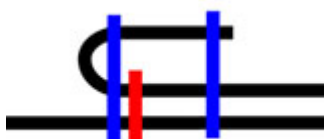
Obrázek 4: Schéma trojitého bezpečnostního švu se skrytým stehem (červeně)
