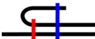
Obrázek 3: Schéma dvojitého bezpečnostního švu s dvojitým štepováním – nejpoužívanější šev.
