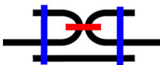
Obrázek 4: Schéma trojitého bezpečnostního švu se skrytým stehem (červeně)
