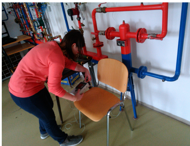
8.6 Zapojení termočláňkových drátů do měřicí ústředny
