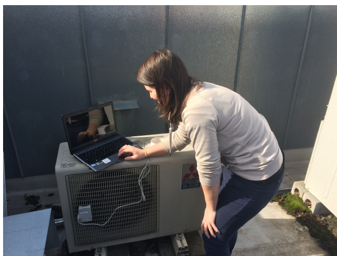
8.8 Stahování dat z dataloggeru
