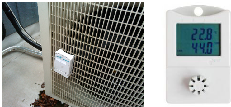
8.7 Datalogger [29] a jeho umístění na venkovní jednotce
