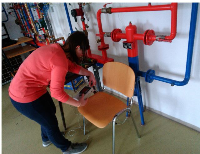
8.6 Zapojení termočláňkových drátů do měřicí ústředny
