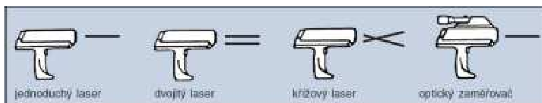
Obr. 3.6 Způsoby zaměření objektu u přenosných pyrometrů (13, s.12)
