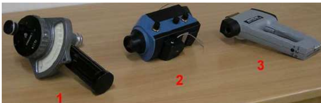
Obr. 4.1 Bezdotykové teploměry používané v laboratořích v minulých letech (13, s.4)
