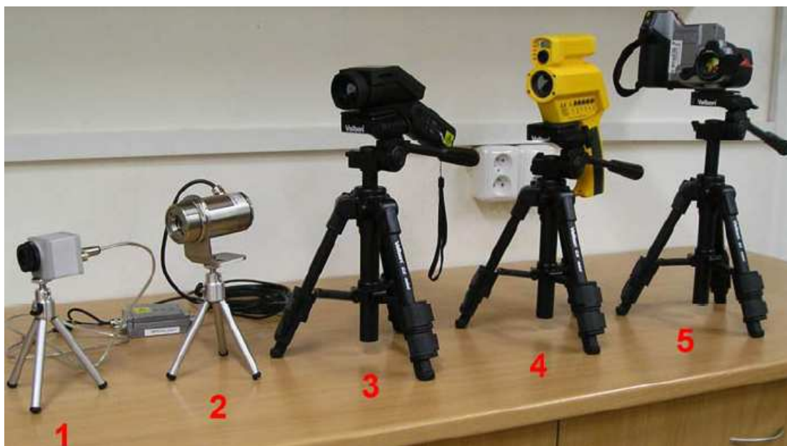
Obr. 4.2 Moderní bezdotykové teploměry a termovizní kamery (13, s.4)
