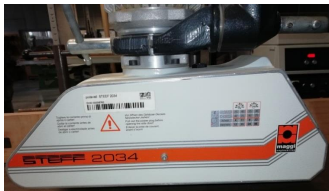
Obrázek č. 22.: Podávací zařízení na frézce
