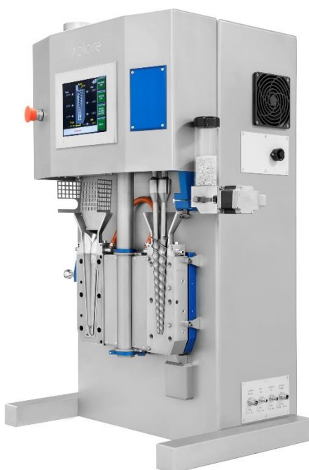
Obr. 3.4 Laboratorní mikro kompaundér Xplore MC 15 HT [40]
