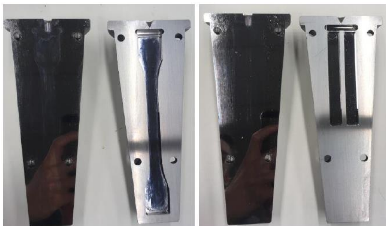
Obr. 3.7 Formy pro vstřikování zkušebních těles typu 1B (vlevo) a těles o rozměrech (80 x 10 x 4) mm (vpravo) [43]
