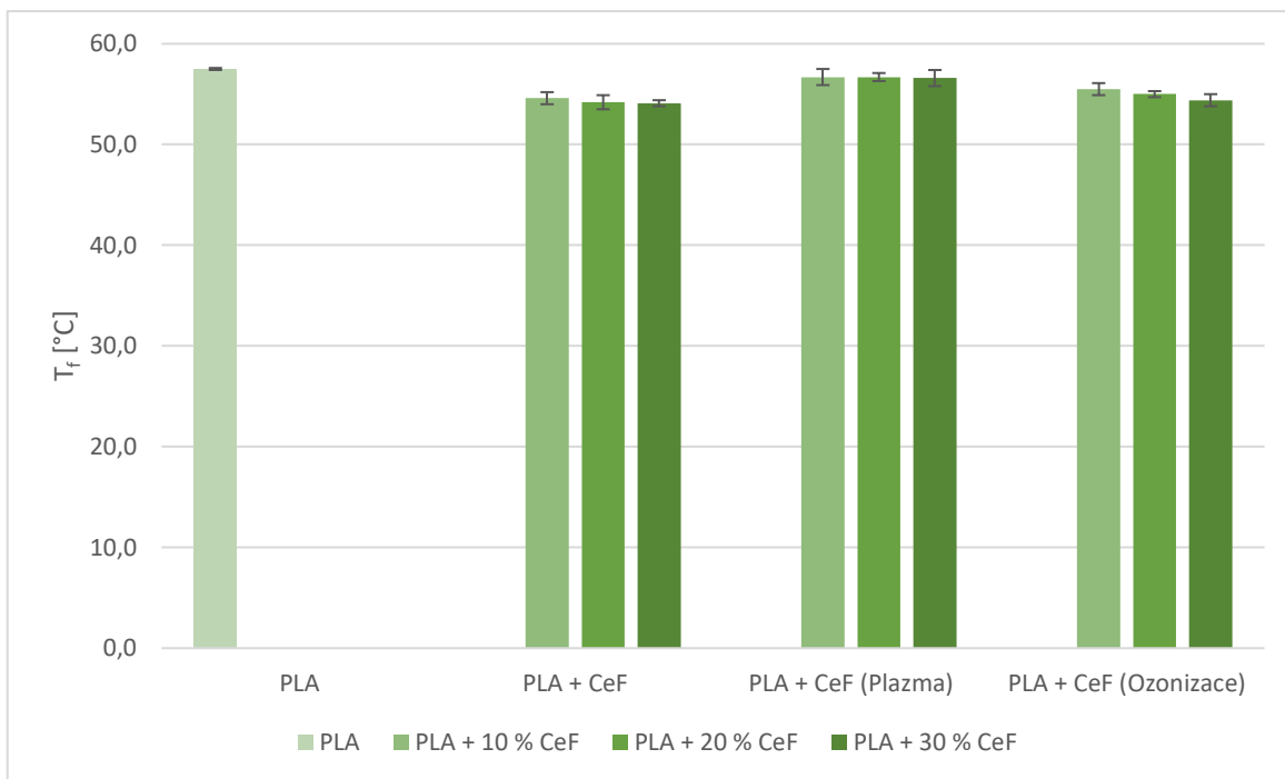
Obr. 4.15 Teplota průhybu při zatížení PLA s hm% celulókových vláken bez a s modifikací plazmou a ozonem
