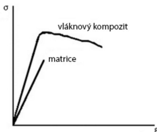
Obr. 2.1 Porovnání tahových diagramů křehké matrice a kompozitu složeného z téže matrice a křehkých keramických vláken [1]
