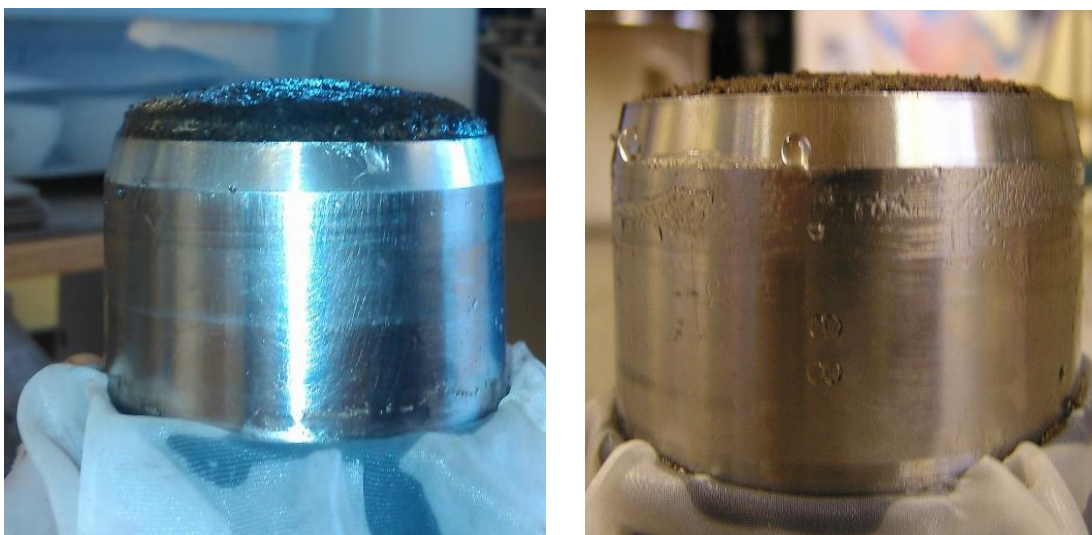
Obr. č. 10 Ukázka porovnání bobtnání 5% biocharu a vzorku bez biocharu.
