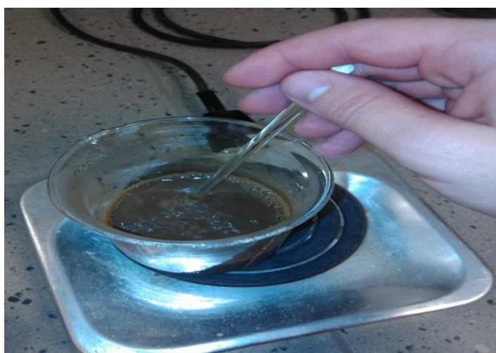
Obr. č. 8 Míchání a vaření roztoku pro měření zrnitosti
