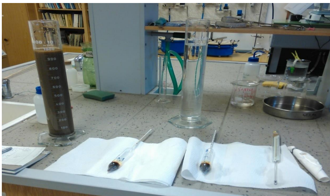
Obr. č. 9 Válce, hustoměry a teploměry pro měření zrnitostní křivky
