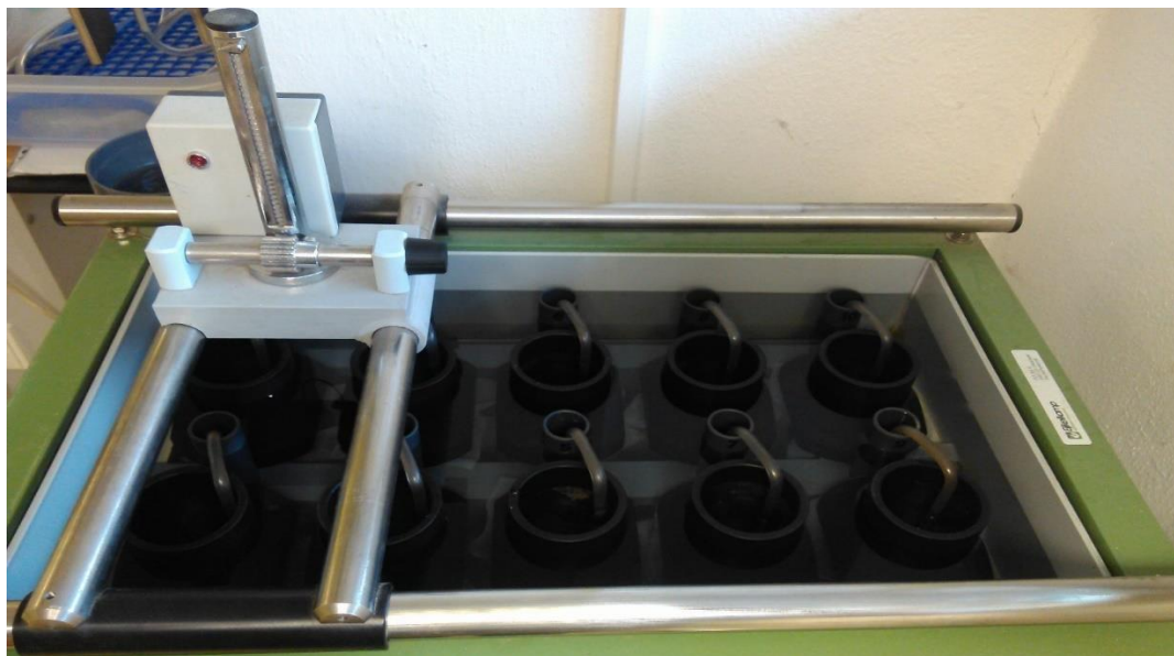
Obr. č. 15 Ukázka hladiny částečně demineralizované vody s umístěním vzorků do permeamtru, dále jsou na obrázku zobrazeny násosky a mikrometr pro měření hladiny vody.
