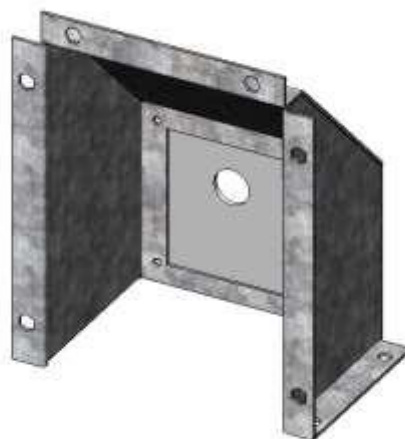
Obr. 25: Model krytu stykača VSC v Solidworks [CAD]
