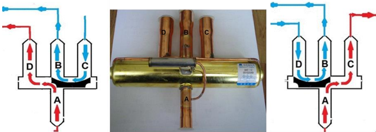
Obrázek 41. Funkce čtyřcestného ventilu. [40]
