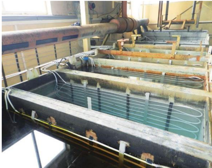
Obrázek 22. Lázně galvanovny, kde je instalováno průmyslové TČ. [24]
