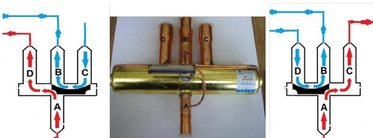
Obrázek 41. Funkce čtyřcestného ventilu. [40]
