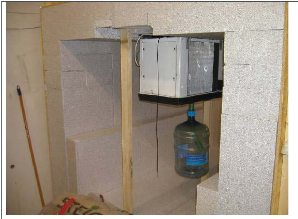
Obr. 56 Izolace měřícího boxu s výparníkem
