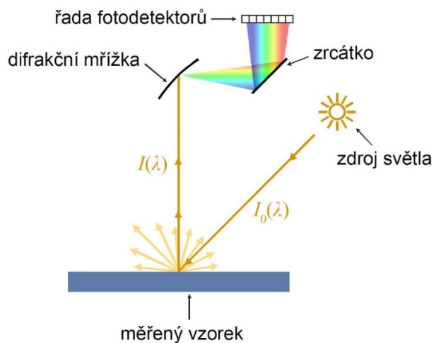
Obr. 13 Princip fungování spektrofotometru (Panák, 2015)
