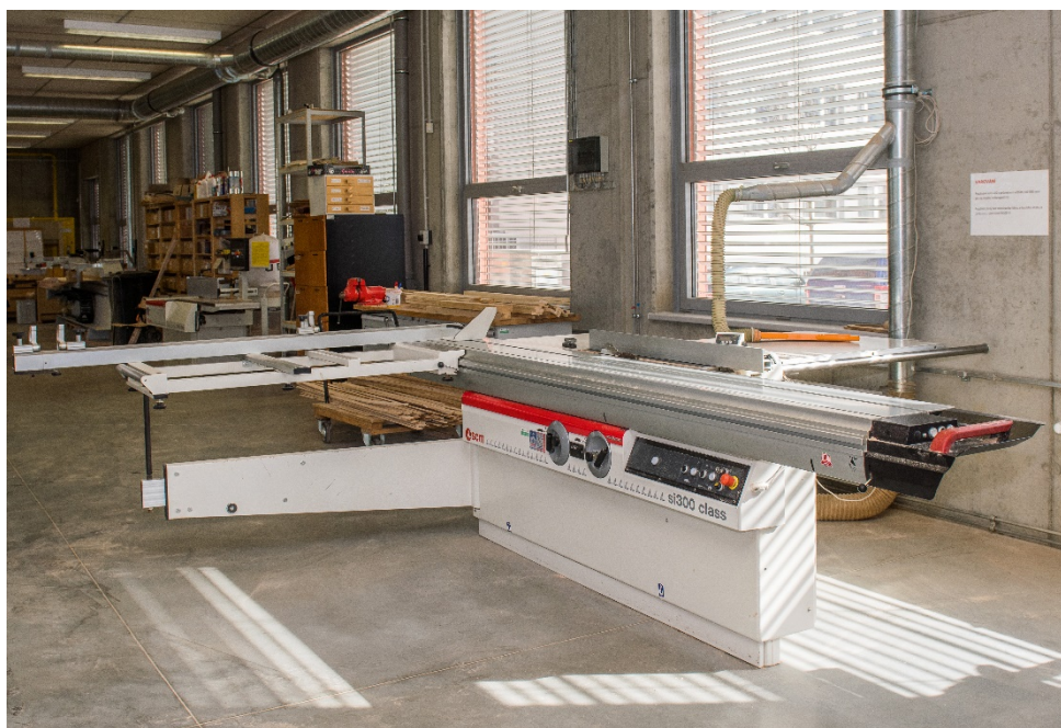
Obr. 22 Výroba referenčních vzorků na kotoučové formátovací pile
