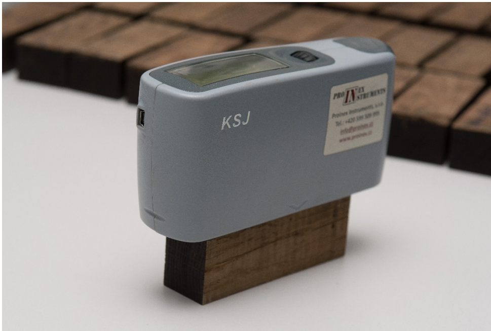
Obr. 26 Měření lesku vzorků v laboratoři
