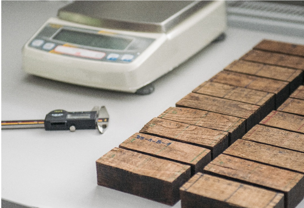
Obr. 23 Zjišťování hustoty a vlhkosti vzorků v laboratoři
